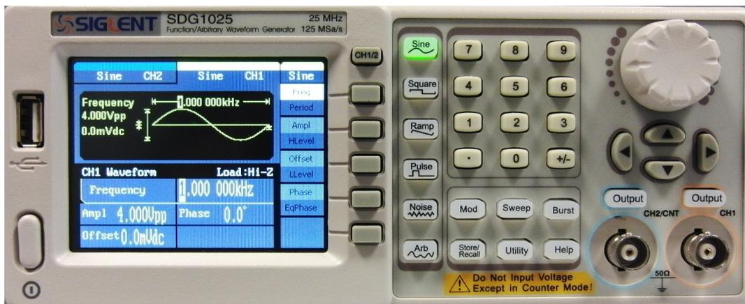
On doit sélectionner la sortie (bouton CH1/2), choisir la forme du signal, ajuster sa fréquence et son amplitude, puis éventuellement lui appliquer un décalage (offset). Pour modifier une valeur (par exemple la fréquence) on peut soit tourner la molette pour modifier le chiffre sélectionné, soit entrer la valeur souhaitée directement au clavier. Attention : une sortie n'est active qu'après appuie sur le bouton OUTPUT situé juste au dessus du connecteur BNC.
