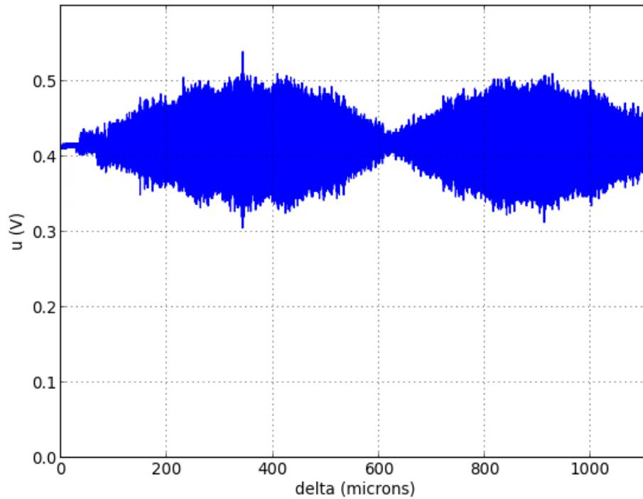
Le miroir passe par le contact optique au cours de l'expérience. Celui-ci est visible par la variation plus grande d'intensité vers  $350 \mu m$ .
