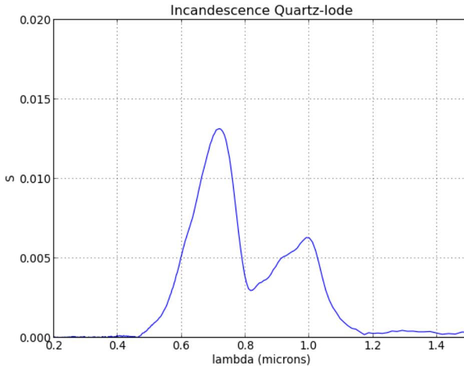
Il faut noter que ce spectre est le produit du spectre de la lumière émise par l'ampoule par le spectre de sensibilité de la photodiode, et par le spectre d'absorption des différents éléments optiques traversés par la lumière entre la lampe et le récepteur.
