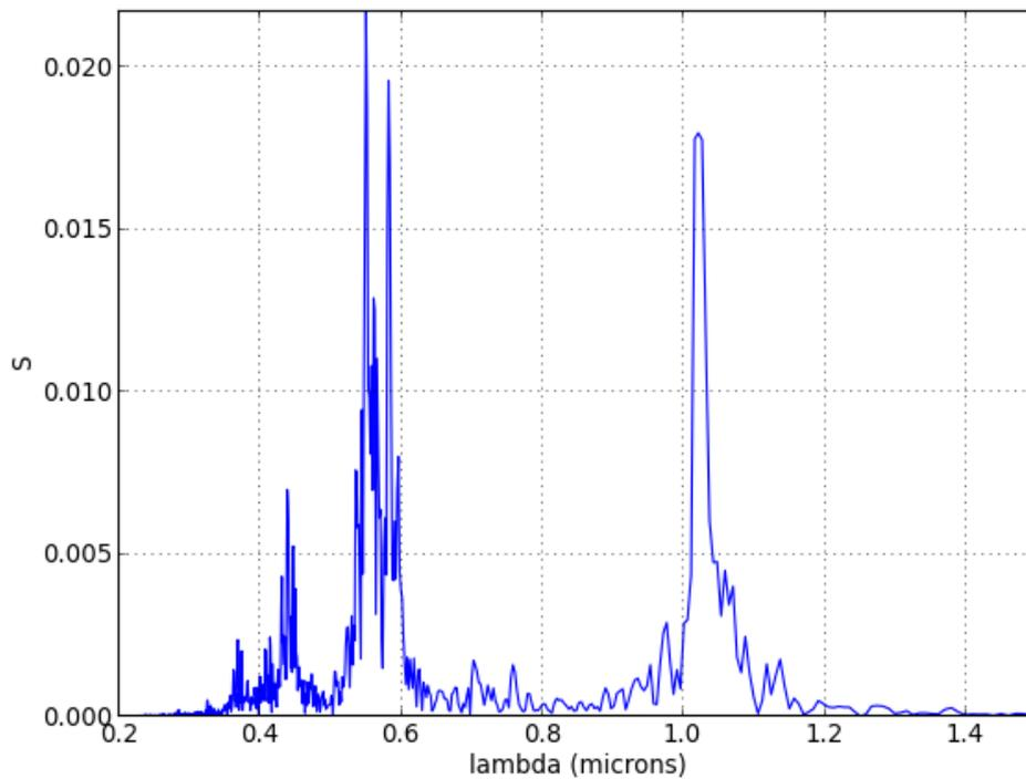
On repère les raies bien connues du mercure : une violette, une bleue, une verte et une jaune (le doublet est non résolu). On voit aussi une raie ultraviolette (très faible car la photodiode est peu sensible aux UV) et une raie infrarouge (là où le capteur est le plus sensible). Plaçons les raies sur la figure :
