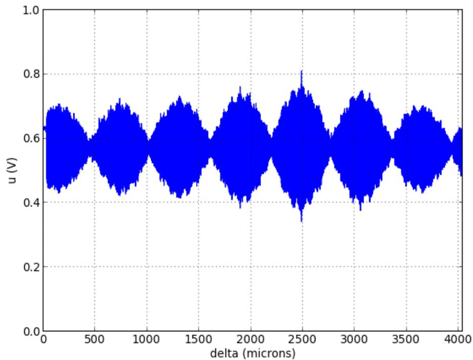
Le contact optique est à  $2500 \mu\text{m}$ . On voit bien les battements dus au doublet du sodium.
