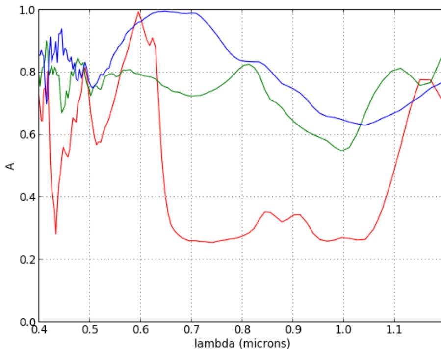
Ces spectres ne sont pas exploitables en dessous de  $0,5 \mu$ , à cause de la trop faible sensibilité de la diode dans ce domaine.
