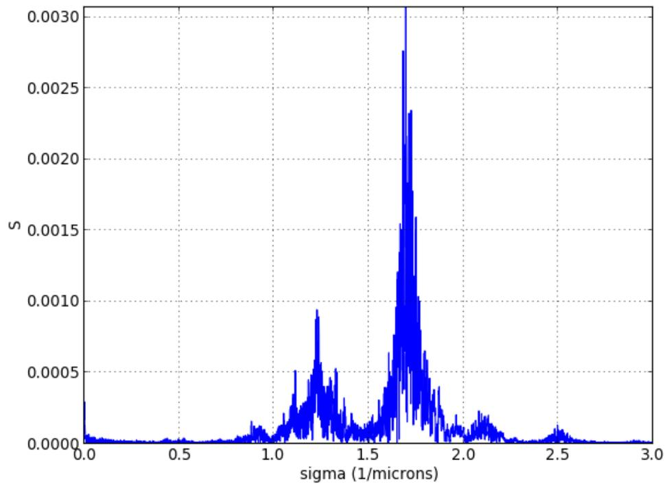
Le spectre obtenu révèle la raie jaune à  $590 \text{ nm}$  et une raie infrarouge vers  $800 \text{ nm}$ .
