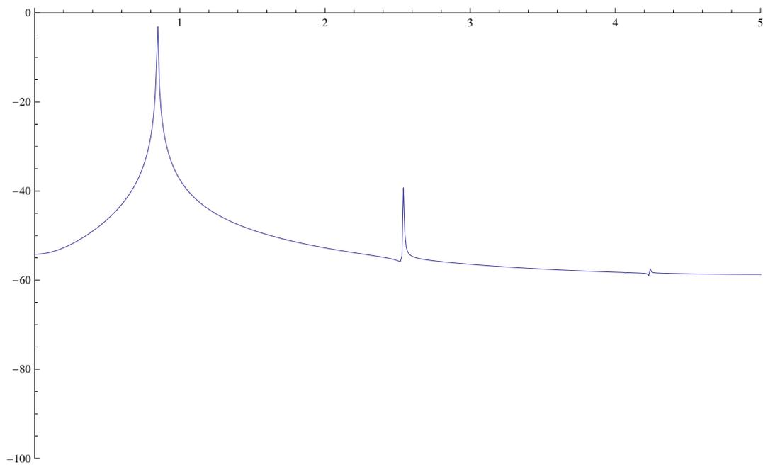
On remarque une baisse de la fréquence d'oscillation et l'apparition d'une harmonique de rang 3. Voyons le résultat avec un angle initial proche de  $\pi$  :
