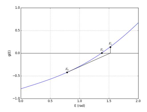
La méthode de Newton-Raphson consiste à calculer une suite d'approximations  $E_i$  qui converge vers la solution. Pour obtenir  $E_{i+1}$  à partir de  $E_i$ , on calcule la dérivée  $g'(E_i)$  et on trace l'intersection de la tangente en  $E_i$  avec l'axe des abscisses. La nouvelle estimation est donc donnée par :
