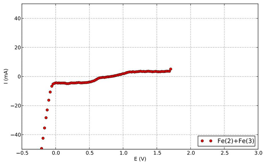
On voit sur cette courbe la réduction de l'eau, qui est rapide sur le platine (le potentiel de Nernst est d'environ  $0\text{ V}$  à  $pH = 0$ ).
