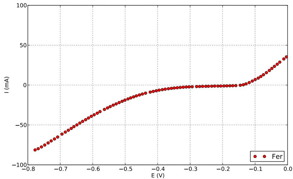
On observe la réduction de l'eau sur la branche cathodique, l'oxydation du fer sur la branche anodique. Voyons plus en détail la zone de faible courant, obtenue avec un calibre de courant dix fois plus faible :
