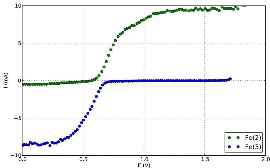
On remarque la présence d'un faible courant de réduction sur la courbe de la solution de sel de Mohr, ce qui montre que le sel utilisé contient un peu d'ions Fer(III).
