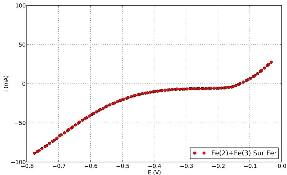
Sur la branche de courant négatif, on observe la réduction de  $\text{Fe(III)}$ , puis la réduction de l'eau à un potentiel beaucoup plus bas que précédemment (environ  $-0,3\text{ V}$ ). Cela montre que la réduction de l'eau sur le fer est lente
