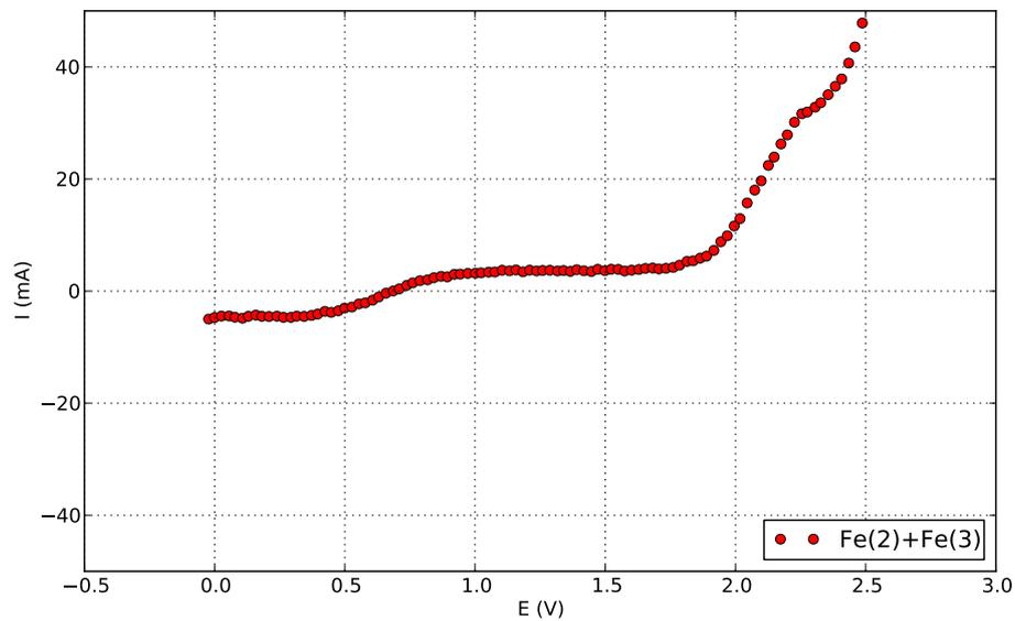
On voit sur cette courbe l'oxydation de l'eau vers 1,7 V puis celle des ions sulfates vers 2,2 V.
