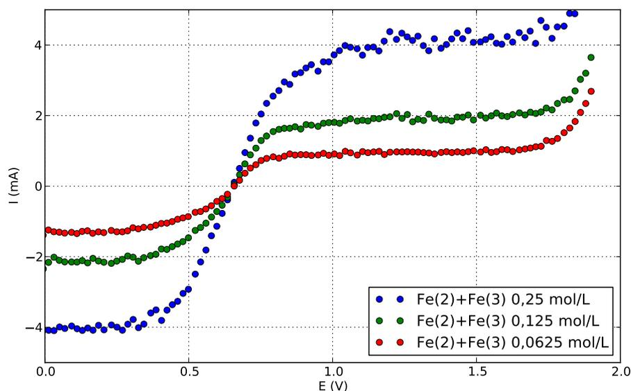
À agitation constante, le courant limite est proportionnel à la concentration de l'espèce électroactive.
