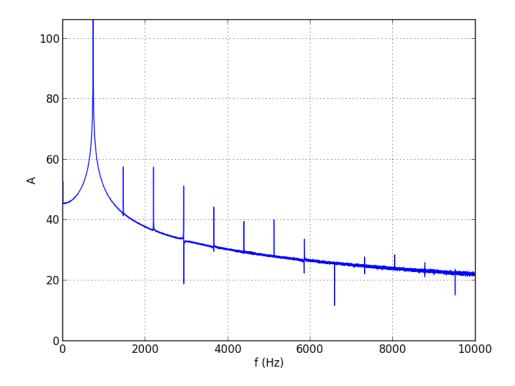
Ce réglage a l'avantage d'être plus stable que le précédent. Le facteur de qualité relativement élevé du filtre (environ 4,5) permet d'obtenir une oscillation pratiquement sinusoïdale en sortie du filtre, avec un taux de distortion inférieur à -50 dB.
