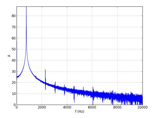
Le spectre montre une oscillation pratiquement harmonique. On observe une harmonique de rang 3 d'amplitude -60 dB par rapport au fondamental.
