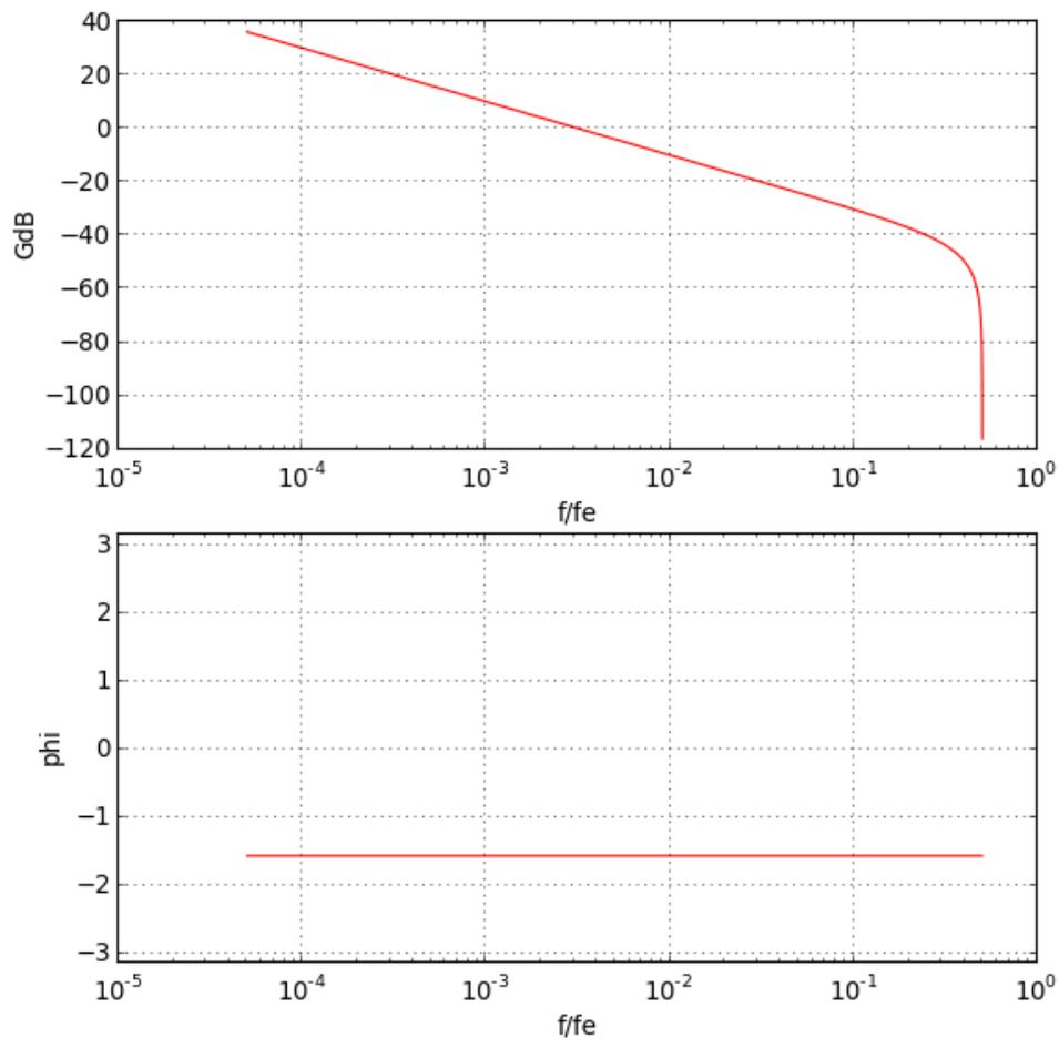
Ce filtre est parfaitement intégrateur, sauf à l'approche de la fréquence de Nyquist ( $f_e/2$ ). Il a toutefois un inconvénient très important : son gain à fréquence nulle est infini, car il intègre aussi une composante de fréquence nulle. En conséquence, une composante continue dans le signal d'entrée (il y en a toujours une, aussi petite soit elle), conduit à une instabilité du filtre.
