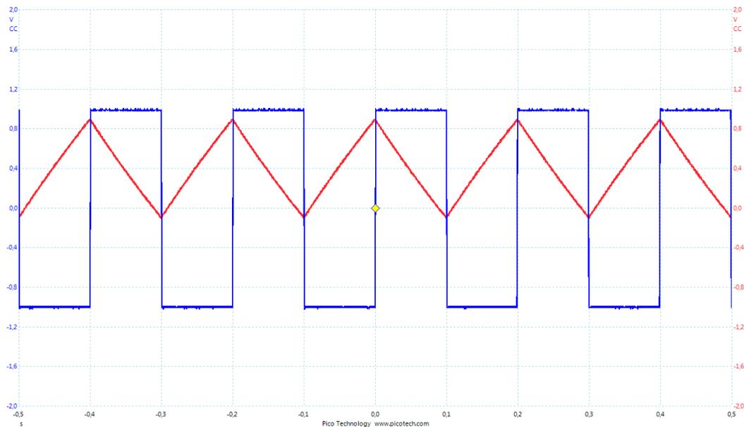
Il apparaît un décalage important en sortie, à cause du courant continu de l'entrée inverseuse qui passe dans la grande résistance de  $10\text{ M}\Omega$ . Pour éviter cet inconvénient, il faut utiliser un ALI à entrées JFET comme le TL081, dont le courant d'entrée est beaucoup plus faible.
