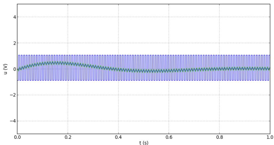
Comme prévu, l'amplitude en sortie est faible. On peut toujours multiplier les coefficients  $b_k$  par une constante plus grande pour augmenter le gain. Le régime transitoire a toujours la même durée absolue.
