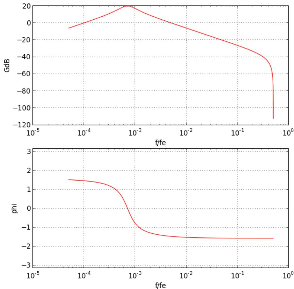
On a multiplié les coefficients  $b_k$  par 10 pour augmenter le gain. Le filtre obtenu supprime bien la composante continue (gain nul à fréquence nulle). La contrepartie est évidemment un domaine intégrateur plus limité, qui commence à environ  $0,002f_e$ , soit  $4\text{ Hz}$  pour la fréquence d'échantillonnage de  $2\text{ kHz}$  utilisée ci-dessus.
