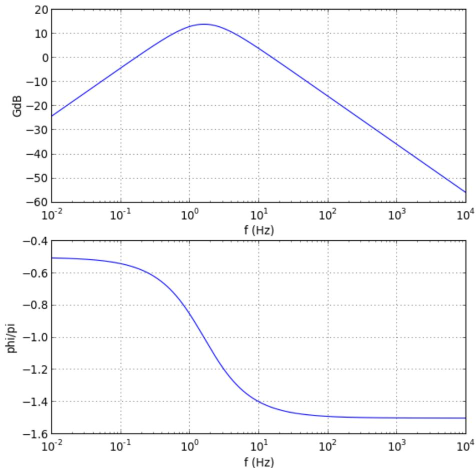
Le filtre est intégrateur lorsque le déphasage est égal à  $-\pi/2$ , environ à partir de 20 *Hz*. Le gain à cet fréquence est de 0 *dB*. Au delà, il décroît de 20 *dB* par décade.
