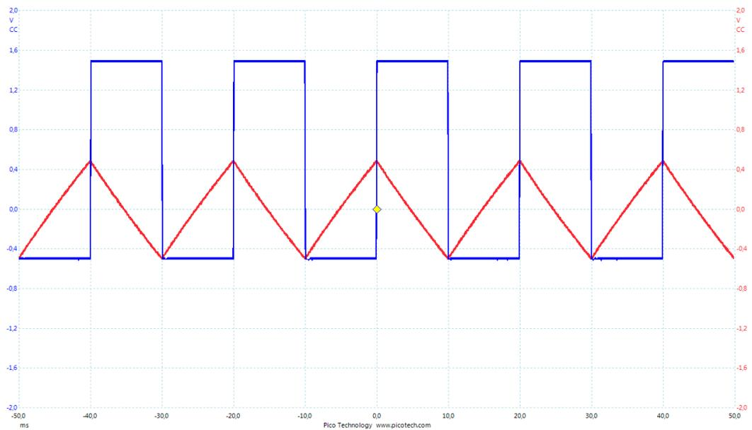
Voici ce qu'il arrive pour le même signal si on remplace le couplage AC en entrée par un couplage DC (en enlevant  $C_1$ ) :
