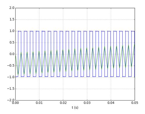
On observe une forte dérive, due à la présence d'une composante de fréquence nulle dans le signal  $x_n$ , bien que celle-ci soit très faible.
