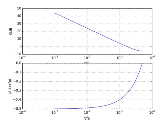
On n'obtient pas du tout le comportement intégrateur recherché, puisque le déphasage devrait être constamment égal à  $-\pi/2$ . La solution consiste à écrire un schéma numérique à deux pas (de type Adams-Moulton) :
