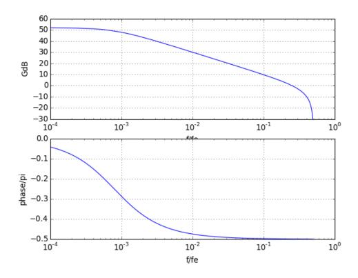
Ce filtre passe-bas a une fréquence de coupure environ égale au millième de la fréquence d'échantillonnage, et un domaine intégrateur qui commence environ au centième de cette fréquence. Voyons la réponse impulsionnelle de ce filtre :
