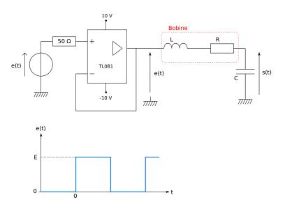
La tension e(t) appliquée au circuit RLC est fournie par un générateur de signaux dont la résistance de sortie est de  $50\,\Omega$ . La résistance interne d'une bobine étant de quelques ohms, il est nécessaire d'appliquer cette tension via un suiveur, réalisé au moyen de l'ALI TL081.
