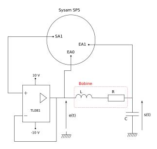
Le script ci-dessous fait l'acquisition de N points sur une durée T. La tension appliquée en sortie (SA1) est nulle pour les  $n_1$  premiers échantillons et pour les  $n_1$  derniers échantillons. Elle est égale à 5 volts pour les échantillons d'indices  $n_1$  et  $N-n_1$ . Les tensions e(t), s(t) lorsque la tension SA1 est égale à 5 volts sont enregistrées dans un fichier.
