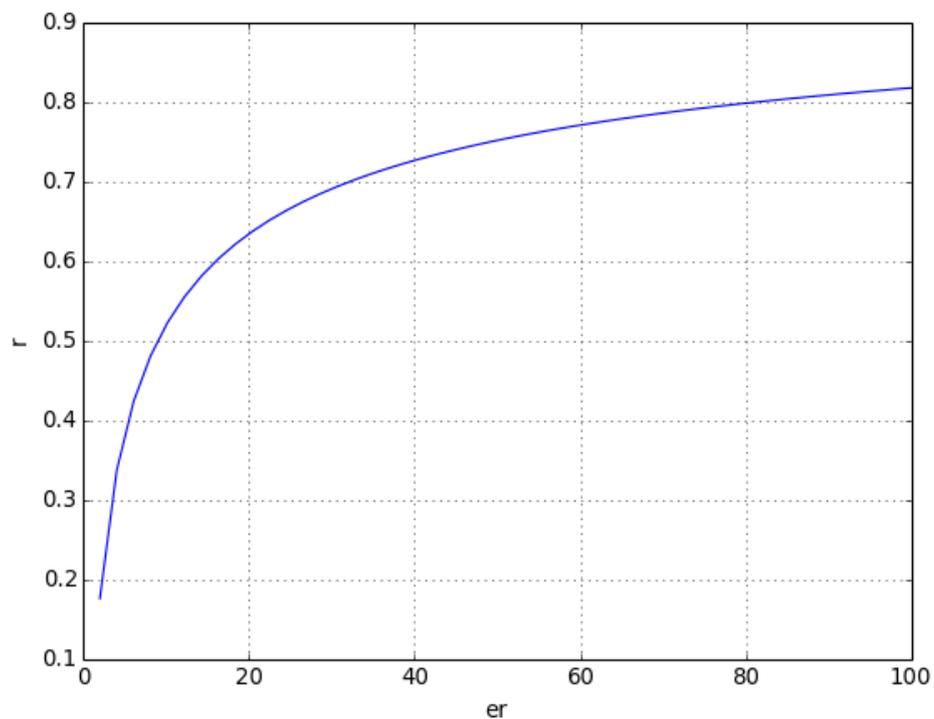
L'impédance d'un milieu isolant ne dépend pas de la fréquence (pour ce modèle ou la permittivité est constante) donc le coefficient de réflexion est insensible à la fréquence.
