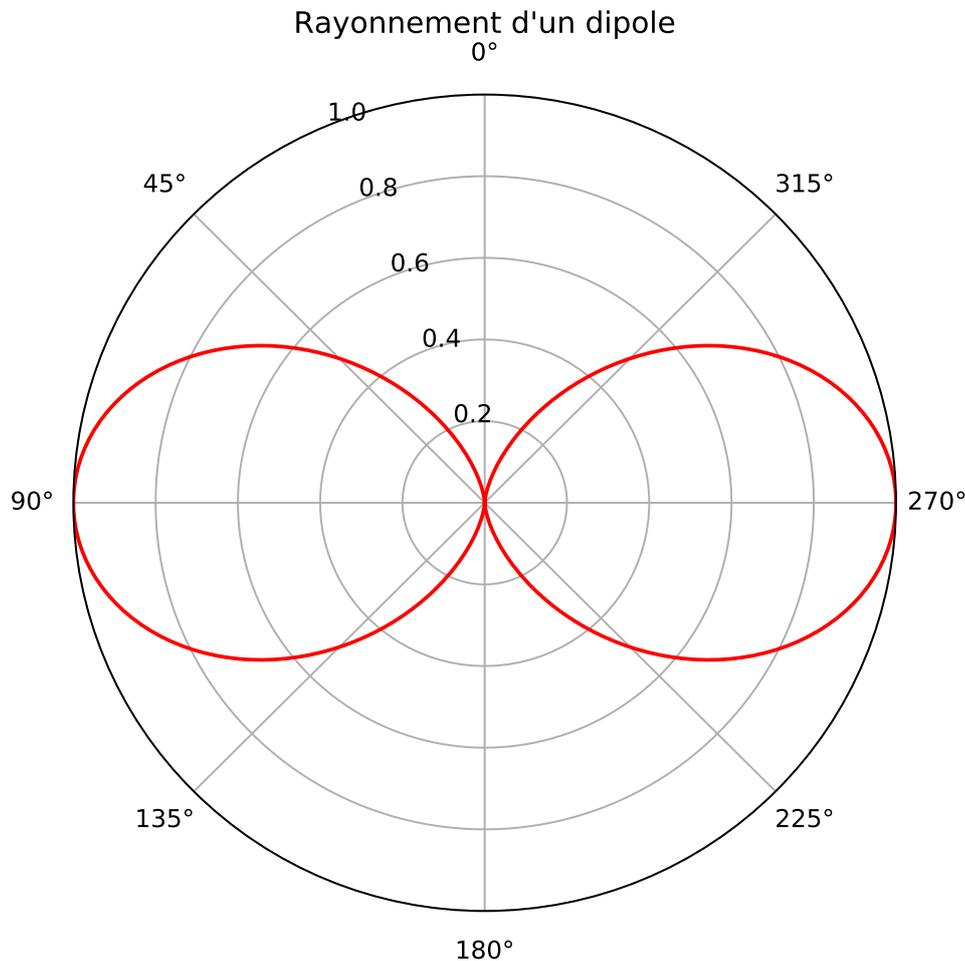
Ce tracé est un diagramme de rayonnement (ou indicatrice de rayonnement). Il permet de voir comment évolue la puissance avec l'angle. On voit par exemple que la puissance est égale à la moitié de sa valeur maximale pour un angle de 45 degrés.
