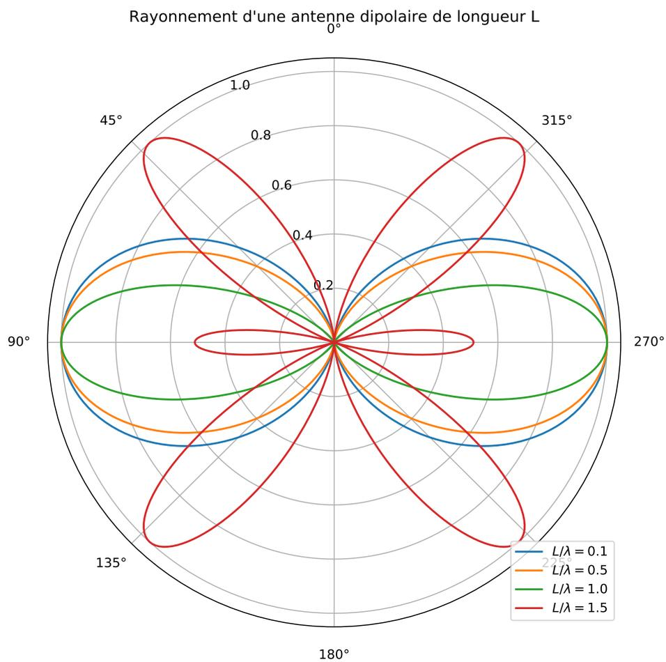
On voit que la directivité de l'émission augmente avec la longueur de l'antenne. Pour  $L > \lambda$ , il apparaît des lobes à 45 degrés, qui deviennent prépondérants lorsque la longueur augmente.
