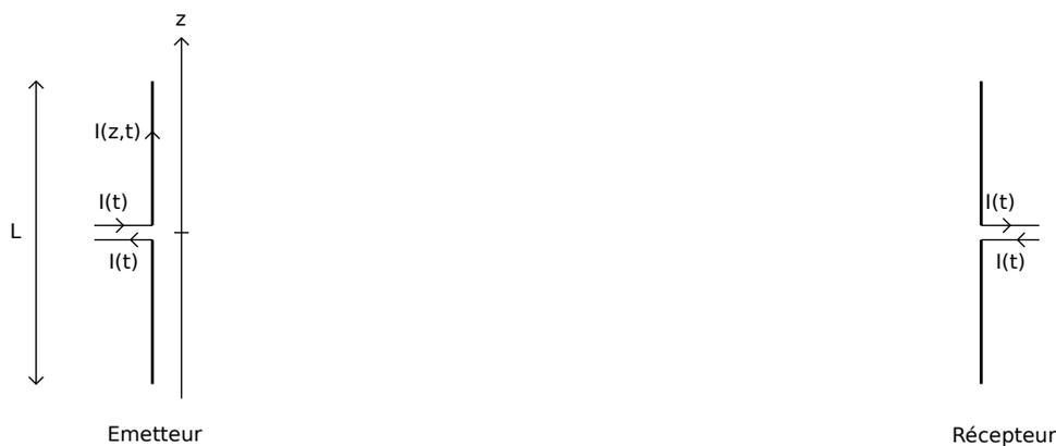
Pour l'étude théorique, on se place en régime sinusoïdal de pulsation  $\omega$ . Si l'on suppose que le rayonnement de l'antenne se fait dans un milieu équivalent au vide (c'est le cas de l'air), la longueur d'onde est :
