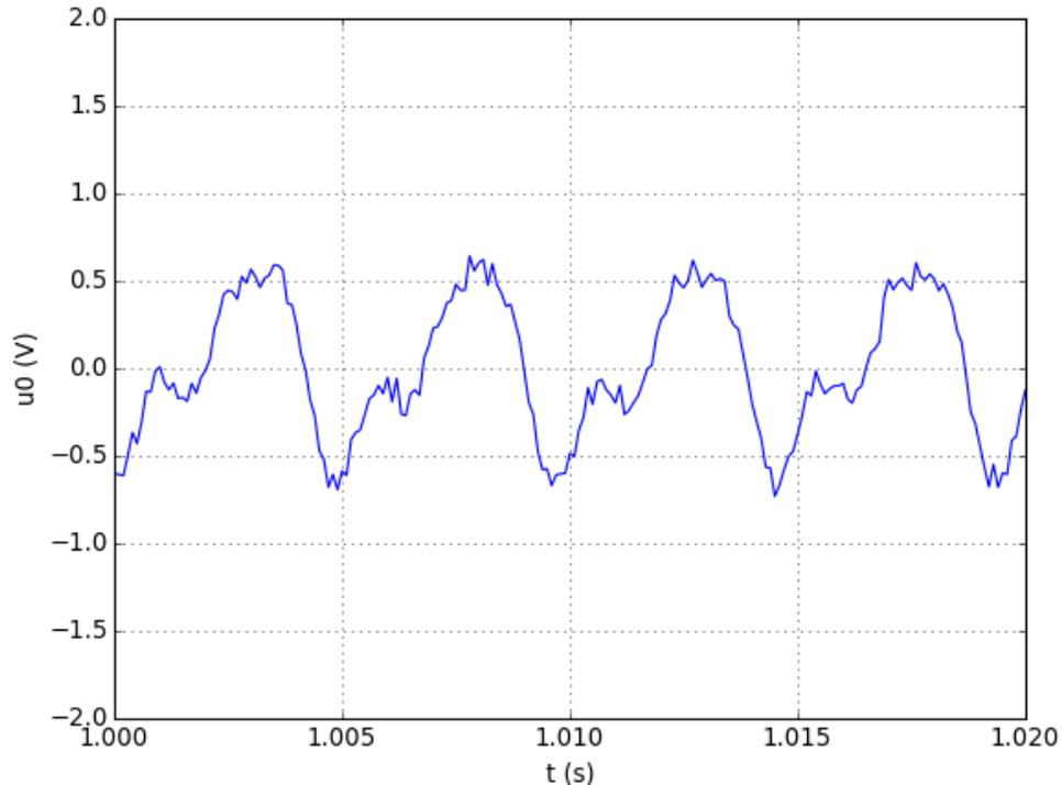
Le signal de la sortie audio a une amplitude maximale de 1 V. On voit bien l'effet du bruit sur le signal échantillonné.
