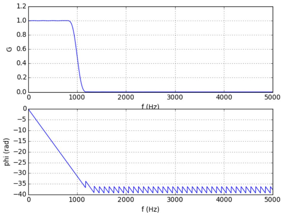
Le gain est égal à 1 jusqu'à 800 Hz et la phase varie linéairement avec la fréquence. Les trois harmoniques du signal (fréquence 207 Hz) sont dans la bande passante.
