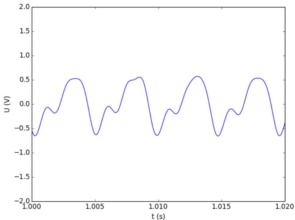
Enfin on fait la conversion numérique-analogique avec la nouvelle fréquence d'échantillonnage :
