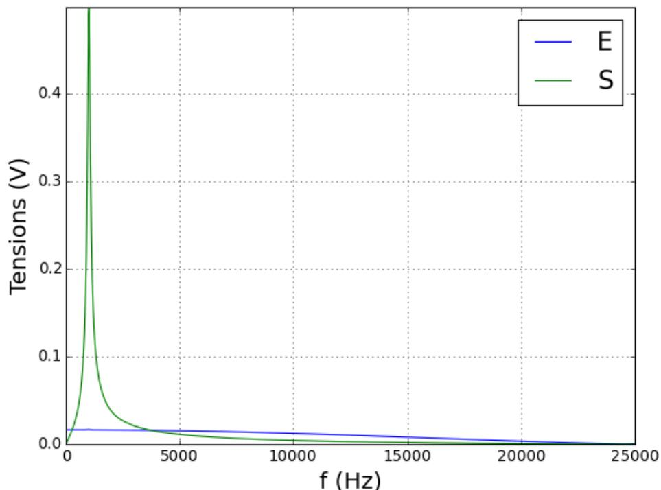
Sur la bande de fréquence  $[0, 10000]$  Hz, le spectre de l'impulsion d'entrée prend une valeur pratiquement constante. On divise le spectre de la sortie par celui de l'entrée afin d'obtenir la réponse fréquentielle du filtre dans cette bande de fréquences :
