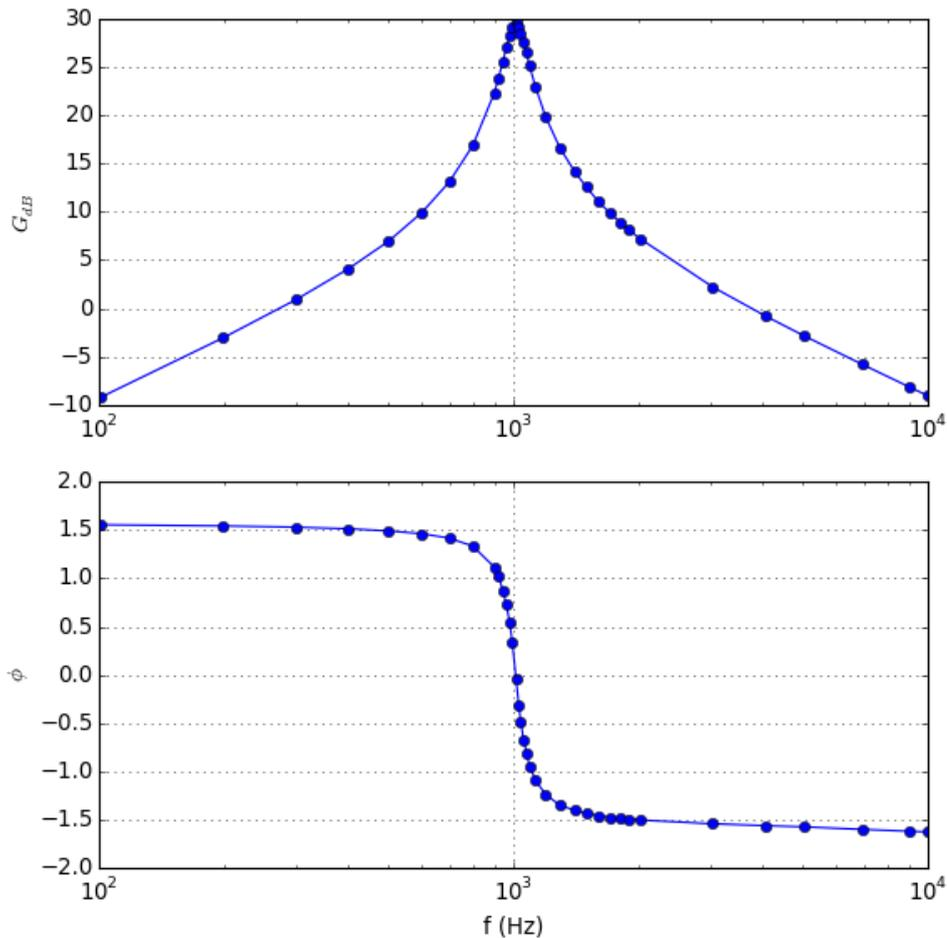
Un tracé du gain  $G$  en fonction de la fréquence en échelle linéaire permet de relever plus facilement la largeur de bande passante et le facteur de qualité :
