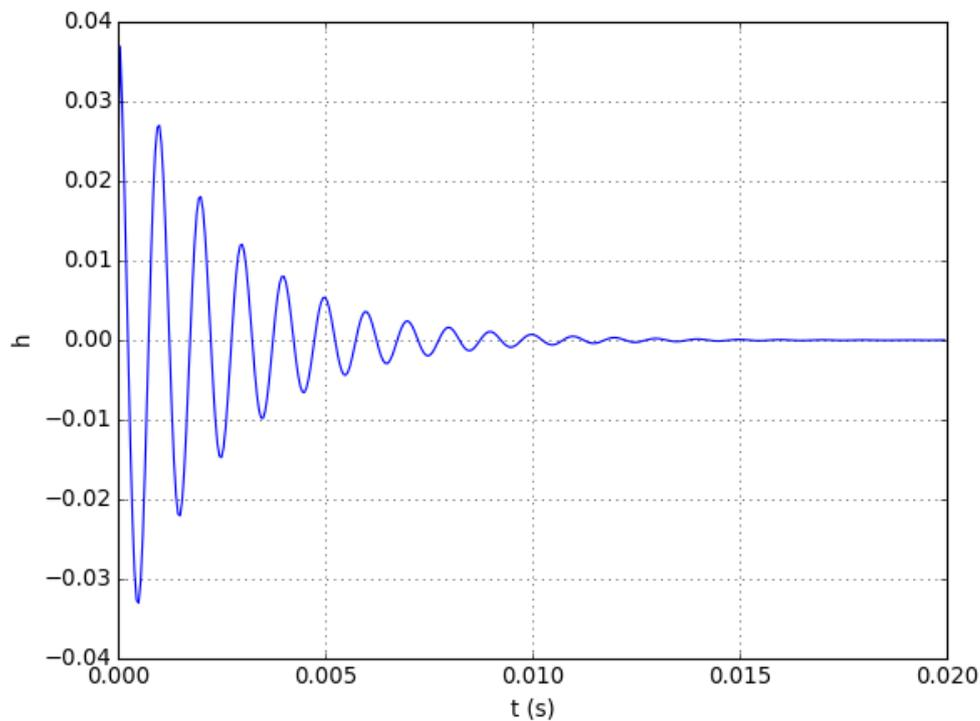
Le coefficient  $r$  (partie réelle des pôles) contrôle le facteur de qualité, qui augmente lorsque  $r$  s'approche de 1. Une comparaison rapide de la réponse impulsionnelle avec celle du filtre analogique (déterminée expérimentalement plus haut) permet d'ajuster le coefficient  $r$  pour obtenir un filtre similaire au filtre analogique.
