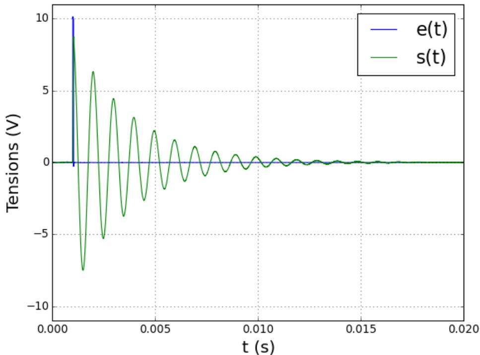
Le rapport des maxima pour  $n = 7$  est  $x = 12,15$ , ce qui conduit à un facteur de qualité  $Q = 8,8$ , identique à la valeur calculée plus haut à partir du gain maximal. En modifiant le réglage du gain  $K$  du filtre, on observe la variation du nombre d'oscillations.
