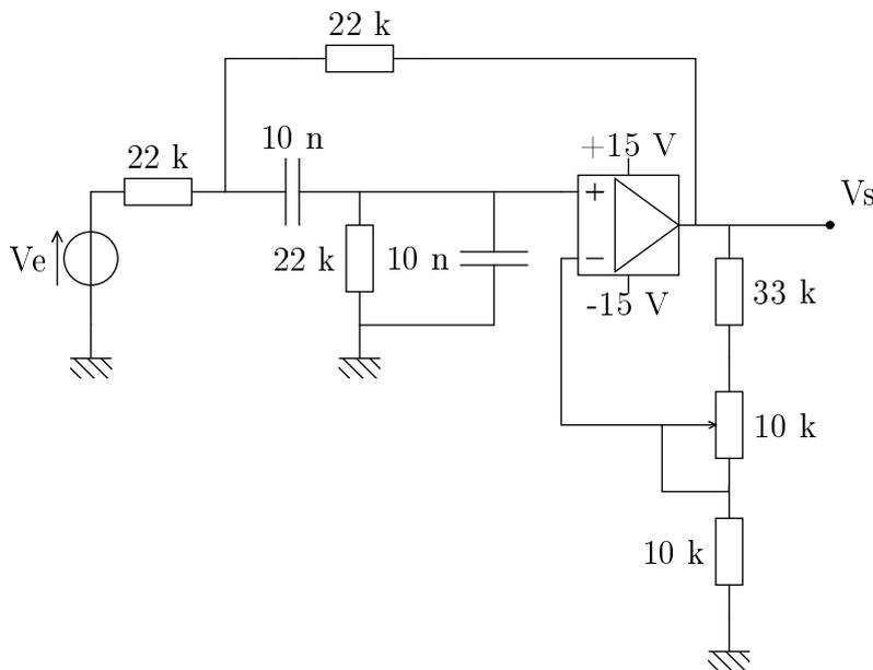
Le bloc constitué de l'amplificateur, des deux résistances et du potentiomètre à sa droite est un amplificateur de gain  $K$ , ajustable entre 4,3 et 5,3 avec le potentiomètre.
