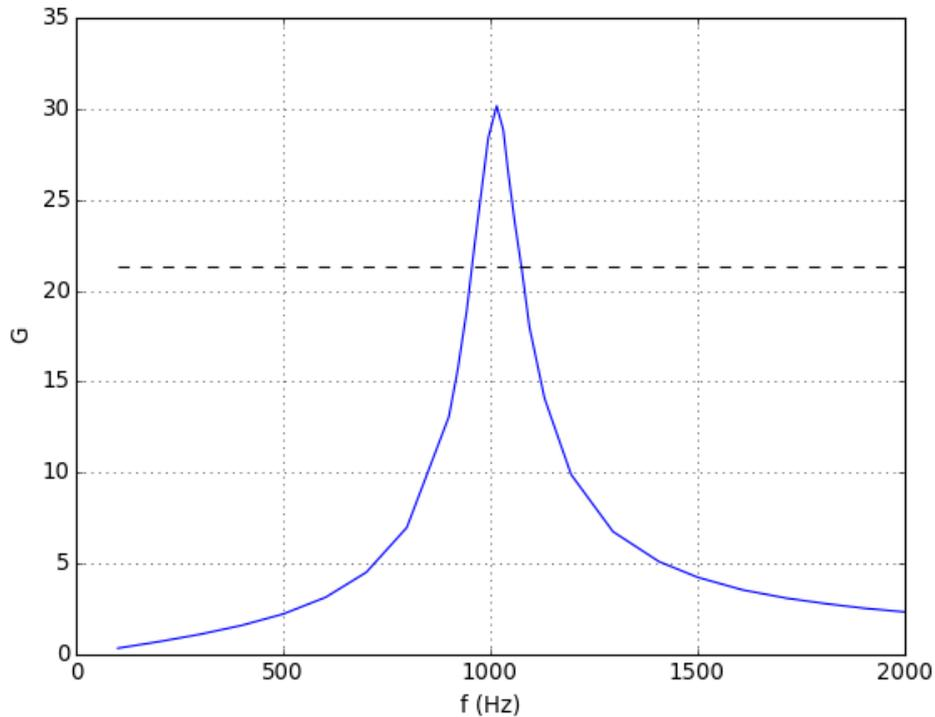
On relève une largeur de bande passante  $\Delta f = 120$  Hz pour une fréquence de résonance  $f_0 = 1009$  Hz, soit un facteur de qualité  $Q = 8,4$ .
