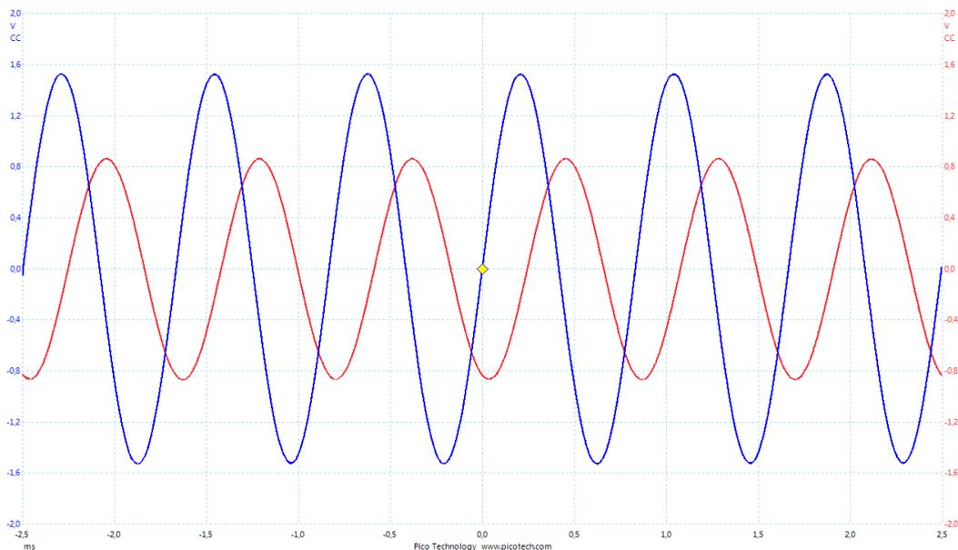
Le délai entre le signal délivré par le GBF et le signal sur la sortie audio est environ égal à la période d'échantillonnage multipliée par la taille  $N$  des paquets. Si l'on augmente la fréquence d'échantillonnage, on peut aussi augmenter proportionnellement la taille des paquets. Par exemple, une fréquence d'échantillonnage de 40 kHz avec  $N = 1000$  fonctionne bien. Le délai est alors de 25 ms.
