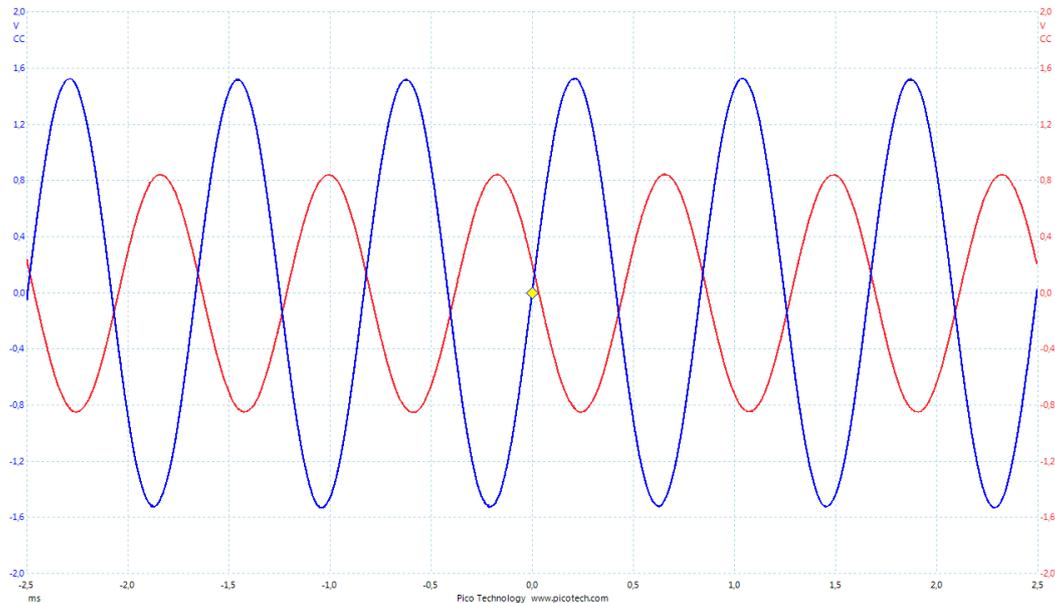
On voit qu'une valeur de 1 envoyée sur la sortie audio donne une tension d'environ 1,6 V. Ce gain dépend bien sûr du réglage du volume. Pour une amplitude en entrée supérieure à 2,1 V (crête à crête), il se produit un écrêtage.
