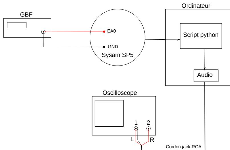
Un générateur de fonctions (GBF) délivre une sinusoïde dont l'acquisition est faite sur la voie EA0 de la carte SysamSP5. Le script python effectue le filtrage en temps réel. Le signal non filtré et le signal filtré sont envoyés sur les deux canaux (R et L) de la sortie audio, pour une observation à l'oscilloscope. On pourra ainsi comparer le signal non filtré et le signal filtré tels qu'ils se présentent dans un filtrage en temps réel réalisé par un circuit DSP.
