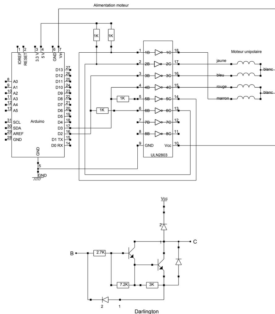
Un niveau logique haut (5 volts) sur la base B du Darlington fait passer le collecteur à une tension proche de zéro (transistor saturé), c'est pourquoi le Darlington est représenté par
