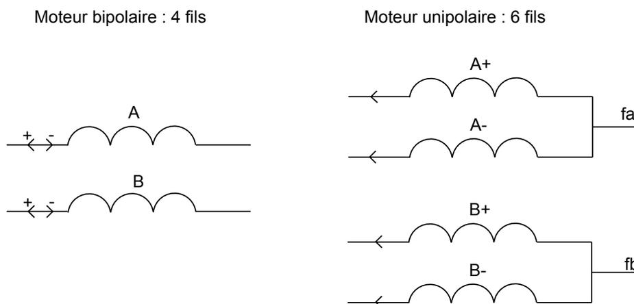
Le sens du courant est aussi représenté. Dans les bobines du moteur unipolaire, le sens du courant est toujours le même, alors qu'il change alternativement dans celles du moteur bipolaire. Les deux bobines d'un même pôle (A ou B) ne doivent pas être alimentées en même temps, car elles produisent deux champs opposés.
