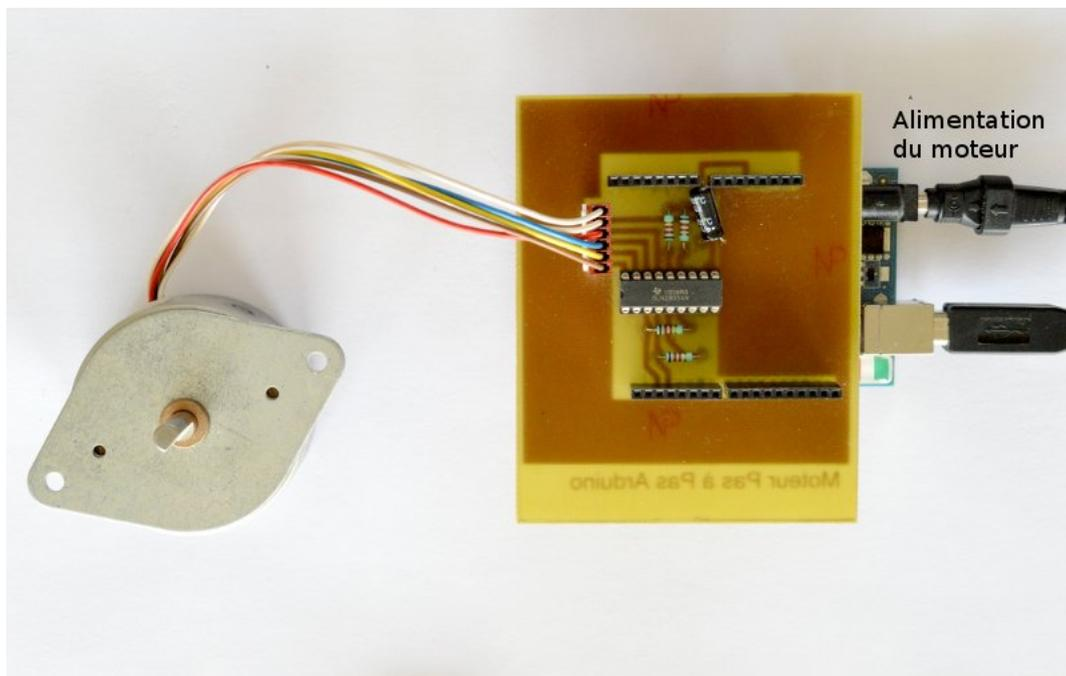
Le moteur utilisé consomme  $300\ mA$  par phase pour une tension de  $12\ V$ .
