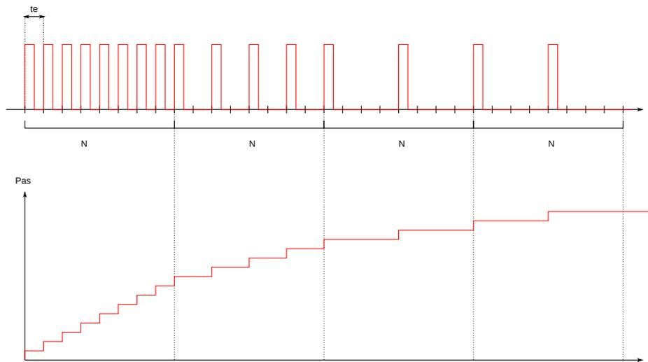
La figure suivante montre la réplification des pas moteurs permettant d'obtenir un mouvement périodique :
