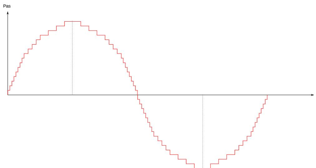
Lors du changement de direction du moteur (à  $t = T/4$  et  $t = 3T/4$ ), le premier pas de l'intervalle doit être enlevé, afin d'assurer la parfaite périodicité de la position angulaire du moteur. Les délais sont stockés dans un tableau. Si 0,1,2,3 sont les indices de ce tableau, la séquence de délais à appliquer est 0,1,2,3,3,2,1,0,0,1,2 etc.
