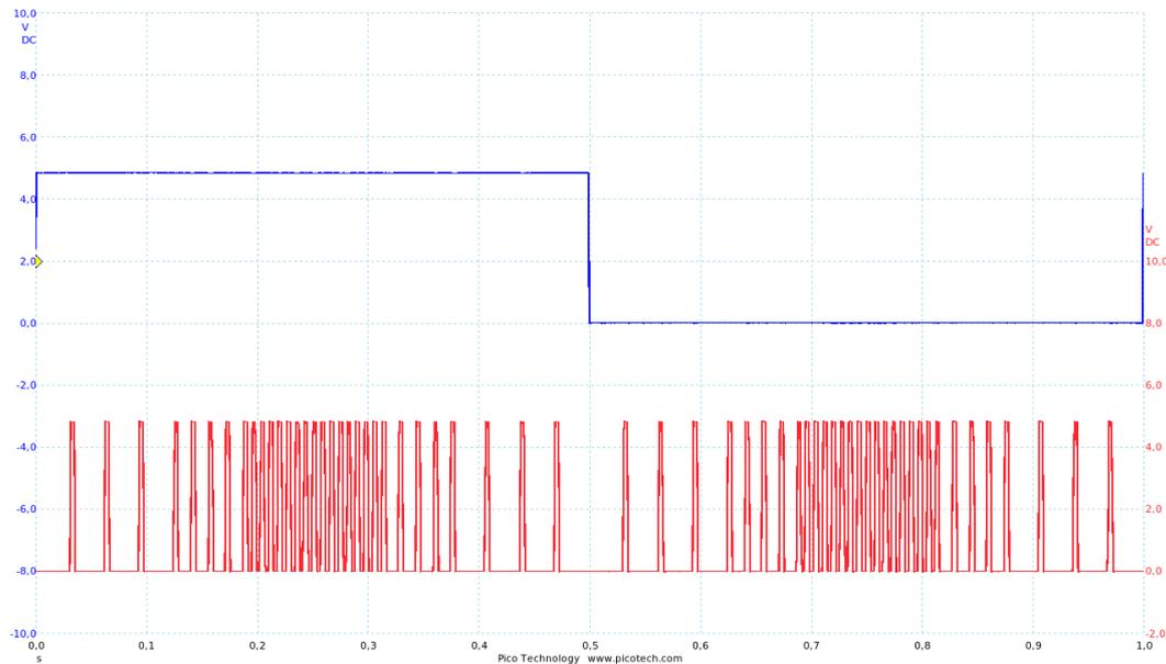
L'amplitude angulaire du mouvement est égale à l'angle de rotation pour un pas (ou un micropas) multipliée par le nombre de pas générés pendant un quart de période. Ce nombre est proportionnel à  $N$ . En doublant  $N$ , on double donc l'amplitude. Pour une période  $T$  donnée, l'augmentation de  $N$  s'accompagne d'une diminution de la période d'échantillonnage.
