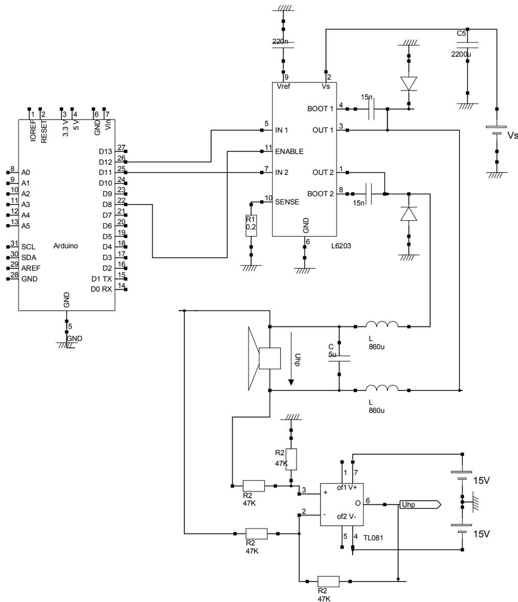
La commande des deux bras de pont (IN1 et IN2) se fait avec les sorties D11 et D12 pour un arduino MEGA. Pour un arduino UNO ou équivalent, il faut connecter les sorties D9 et D10.
