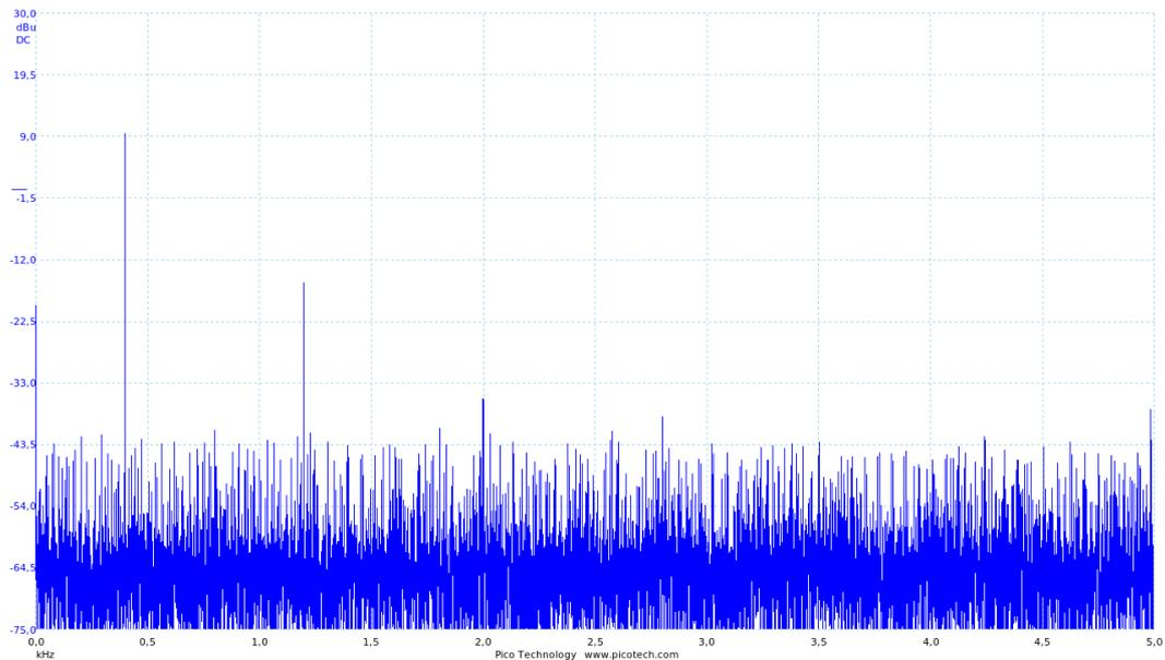
Il a une distorsion bien visible mais faible, avec une harmonique de rang 3 à  $-25\text{ dB}$  du fondamental.
