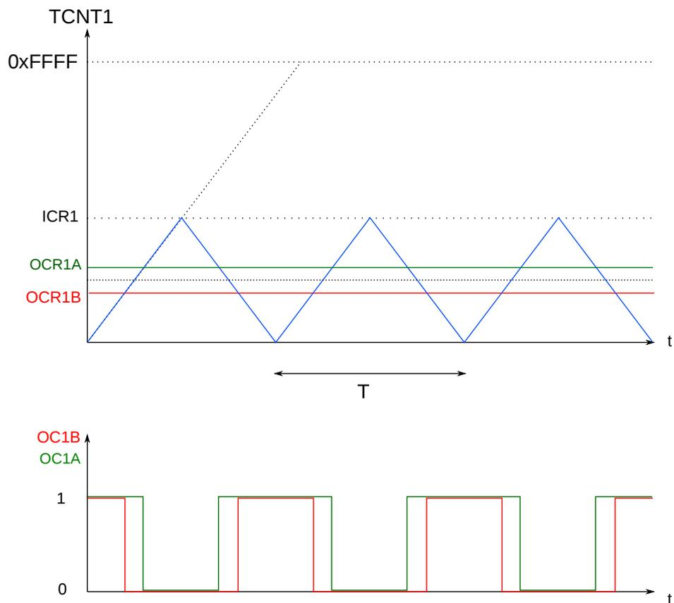
La sortie A est au niveau haut lorsque le compteur est en dessous du seuil OCR1A. La sortie B est au niveau haut lorsque le compteur est en dessous du seuil OCR1B.
