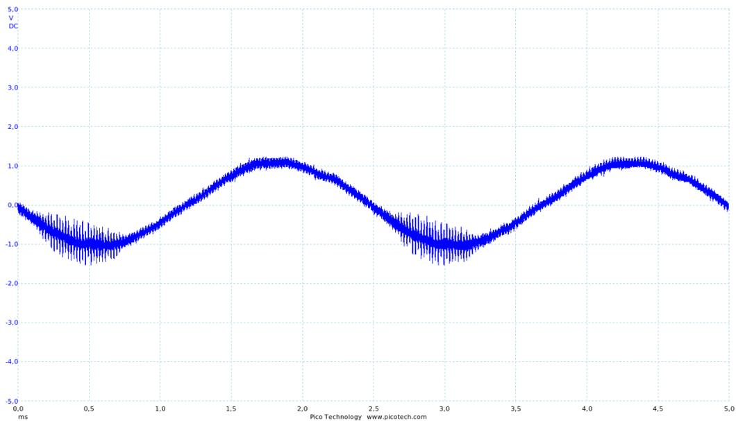
Voici un détail, qui permet de bien voir les ondulations à la sortie du filtre LC :
