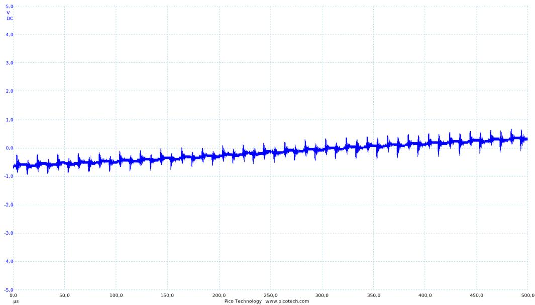
Comme prévu, la même amplitude donne une tension deux fois plus élevée. L'ondulation est très faible mais il y a des pics de tension bien visibles au moment de la commutation des transistors. Ceux-ci n'ont aucun effet sur la qualité du son émis.
