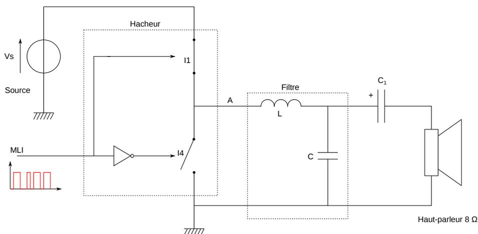
Lorsque le signal de commande est à l'état haut, l'interrupteur  $I_1$  connecte la charge à la source d'énergie alors que  $I_4$  est ouvert. Lorsque le signal de commande est à l'état bas, la charge est connectée à la masse alors que  $I_1$  est ouvert. La tension au point A est en principe la réplique du signal MLI avec l'amplitude  $V_s$ , si la source se comporte parfaitement comme une source de tension.
