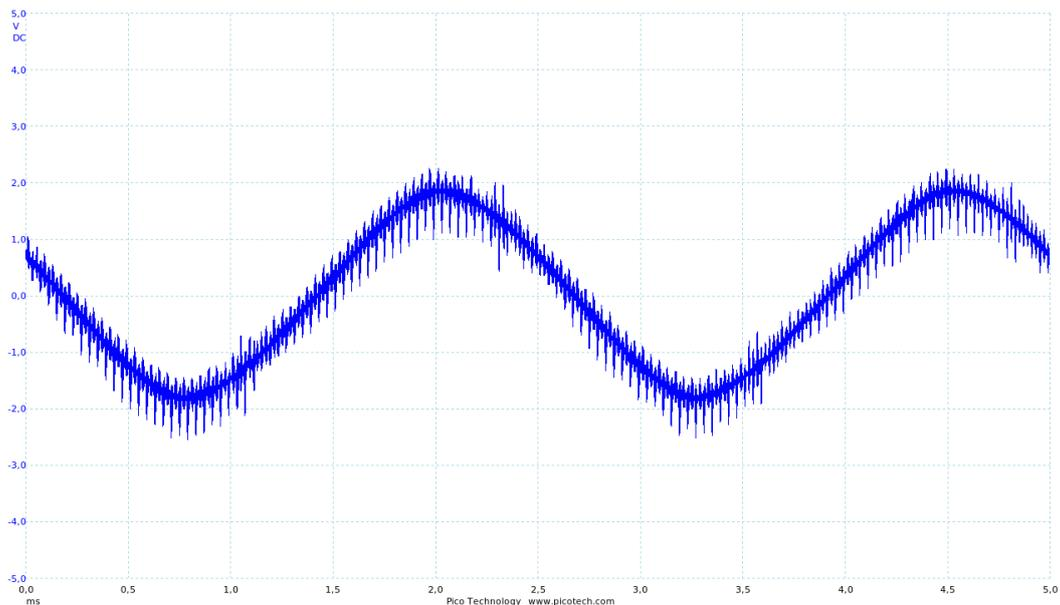
Avec les tores en poudre de fer, on peut augmenter encore l'amplitude tout en restant à un niveau de distorsion faible. Voici la tension pour une amplitude de 0,5 (la tension d'alimentation est toujours  $12 V$ ) :
