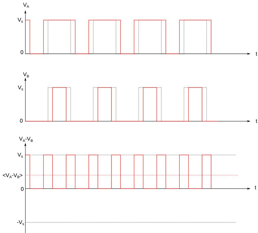
Comparé à la modulation précédente, la tension entre les deux points A et B varie deux fois moins. Il y a trois états de sortie :  $0$ ,  $-V_s$  et  $+V_s$ . De plus la fréquence de découpage finale est le double de la fréquence des signaux de commande.
