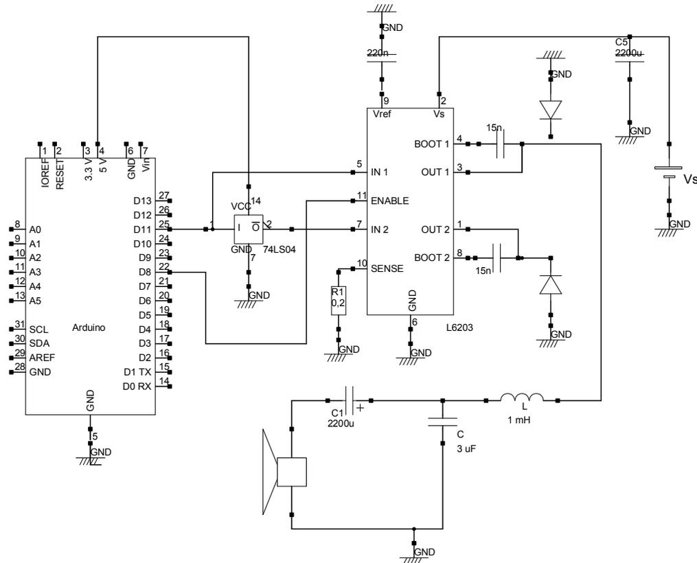
La source d'énergie est une alimentation stabilisée en tension. La tension délivrée est  $V_s = 12\text{ V}$ , qui est le minimum pour que le pont MOSFET fonctionne correctement. On peut monter la tension jusqu'à  $48\text{ V}$  si l'on souhaite augmenter la puissance sonore.
