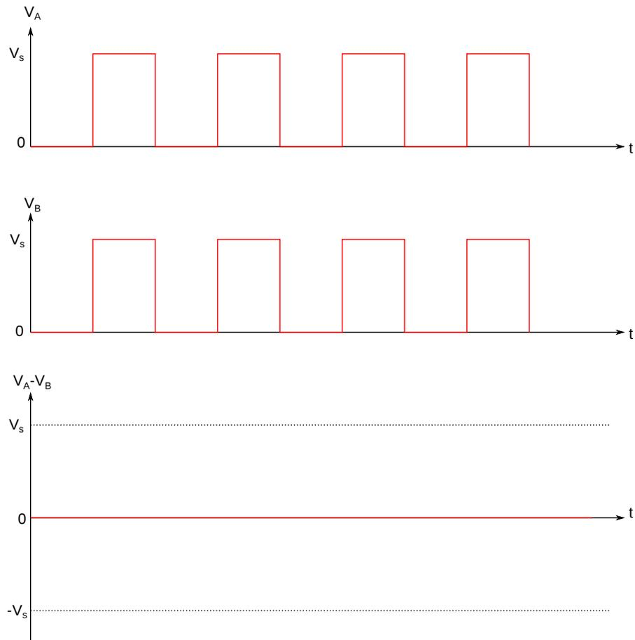
Pour obtenir une tension différentielle moyenne positive, il faut alors augmenter le rapport cyclique de  $V_A$  tout en réduisant celui de  $V_B$  :
