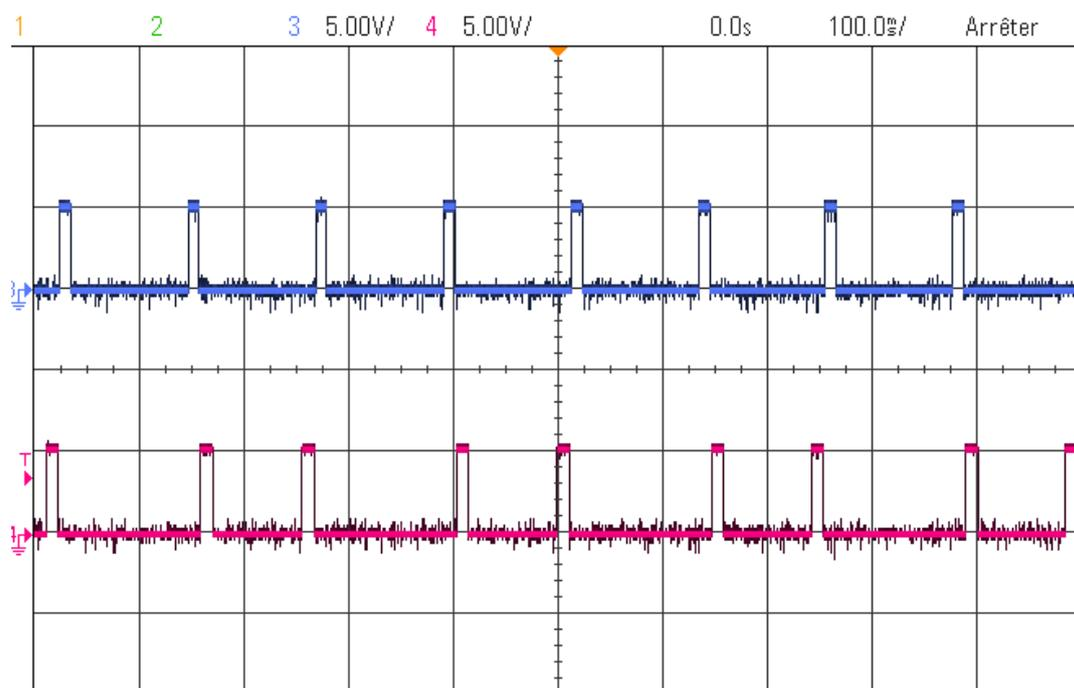
Le signal de la photodiode D1 située sur l'axe est sur la voie 3 (en bleu). Sa période est la moitié de la période d'oscillation du barreau, qui est ici d'environ 240 ms. Le signal
