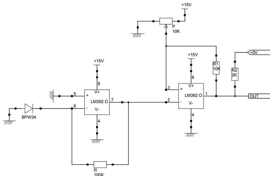
Le potentiomètre permet de régler la tension de seuil du comparateur. Pour éliminer les basculements multiples à la sortie du comparateur (à cause du bruit dans le signal d'entrée), une résistance R1 relie la sortie à l'entrée non inverseuse, ce qui permet d'obtenir un hystérésis.
