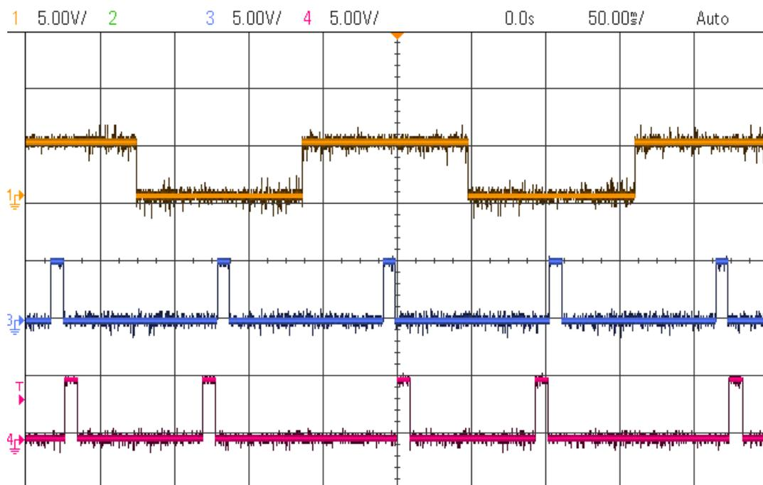
Le champ oscillant  $B_y$  est en quadrature par rapport au signal A. On en déduit que le barreau passe sur l'axe x lorsque le champ  $B_y = 0$ . La période d'oscillation du barreau est égale à celle du champ.
