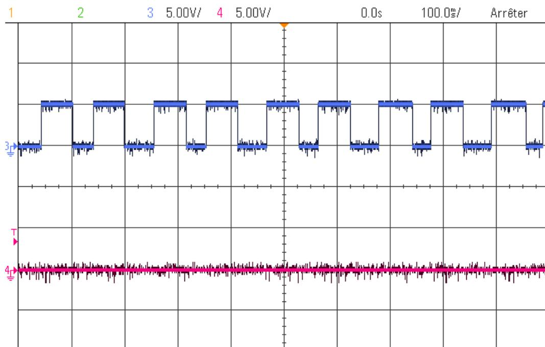
L'ombre ne parvient pas à la diode D2, mais les oscillations sont encore détectées sur la diode D1.
