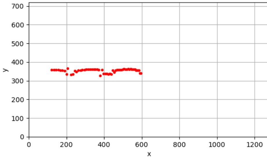
La position est légèrement décalée vers le bas lorsque la partie orange détectée ne s'étend pas jusqu'en haut du cylindre, ce qui d'ailleurs permet d'accéder à la vitesse de rotation du cylindre.
