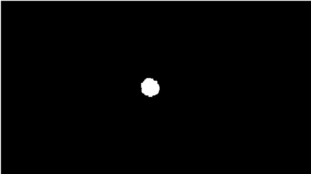
La dilatation permet de supprimer les trous noirs mais elle a l'inconvénient d'élargir la zone. Dans le cas présent cela n'est pas gênant car on s'intéressera seulement au barycentre des pixels blancs. Pour réduire la zone, il suffit d'appliquer une érosion, qui consiste à remplacer chaque pixel par la valeur minimale du voisinage :
