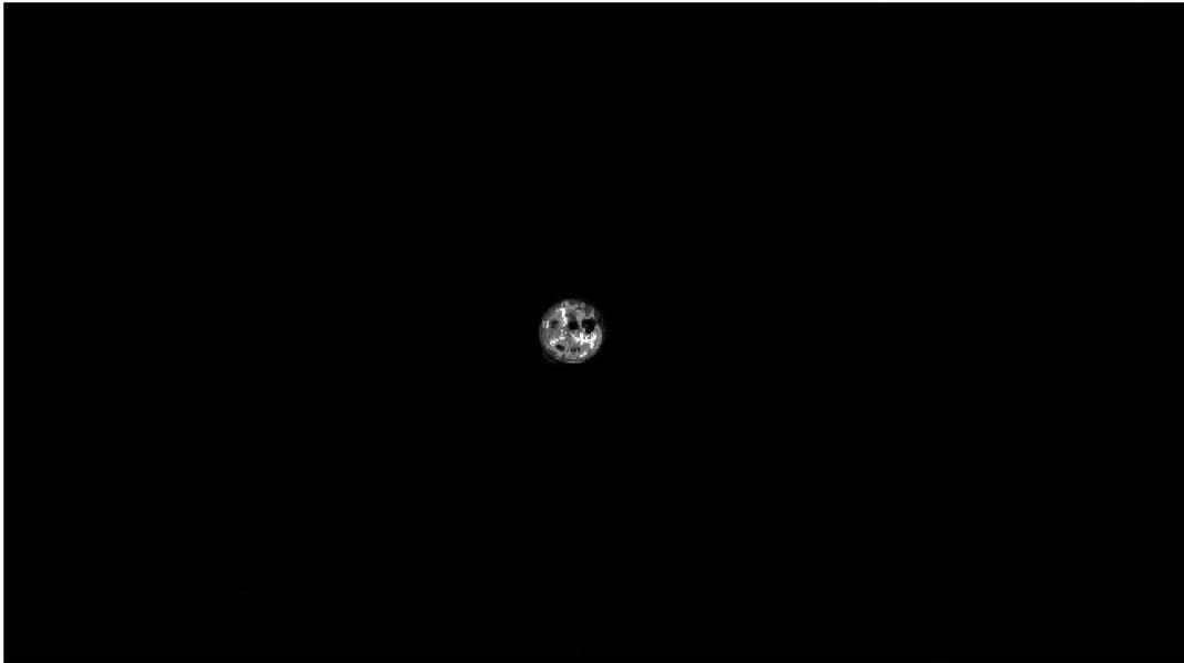
La rétroprojection donne une valeur non nulle seulement aux pixels dont la teinte et la saturation sont dans le domaine du plan HS où l'histogramme de la bille rouge présente des valeurs non nulles. L'étape suivante consiste à binariser l'image en appliquant un seuil :
