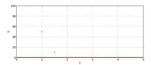
On obtient une restitution parfaite des coefficients de Fourier (multipliés par T). En effet, lorsque T correspond à une période du signal, la TFD fournit les coefficients de Fourier, comme expliqué dans Transformée de Fourier discrète : série de Fourier. En pratique, cette condition n'est pas réalisée car la durée d'analyse est généralement indépendante de la période du signal. Voyons ce qui arrive pour une période quelconque :
