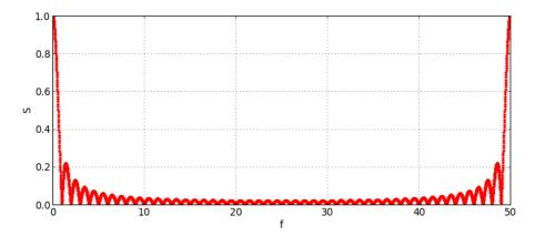
Une fonction présentant une discontinuité comme celle-ci possède des composantes spectrales à haute fréquence encore non négligeables au voisinage de fe/2. Le résultat du calcul est donc certainement affecté par le repliement de bande.
