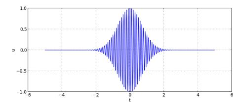
Dans ce cas, il faut choisir une fréquence d'échantillonnage supérieure à 2 fois la fréquence de la sinusoïde, c.a.d. fe > 2/b.
