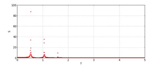
On constate un élargissement de la base des raies. Le signal échantillonné est en fait le produit du signal périodique défini ci-dessus par une fenêtre h(t) rectangulaire de largeur T. La TF est donc le produit de convolution de S avec la TF de h:
