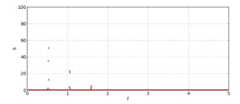
On obtient ainsi une réduction de la largeur des raies, qui nous rapproche du spectre discret d'un signal périodique.
