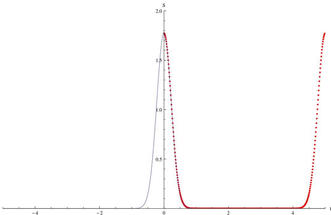
La fréquence d'échantillonnage doit vérifier le critère de Shannon :  $N/T$  doit être supérieur à 2 fois la plus grande fréquence présente dans le spectre. Voici un exemple où ce critère n'est pas vérifié :
