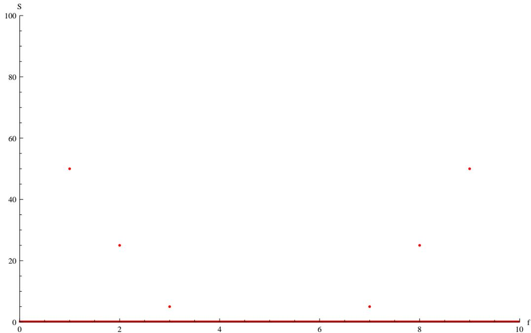
On reconnaît dans le spectre les raies correspondant aux 3 harmoniques. Les coefficients de Fourier se retrouvent en divisant par  $T$ . Modifions la fréquence du signal :
