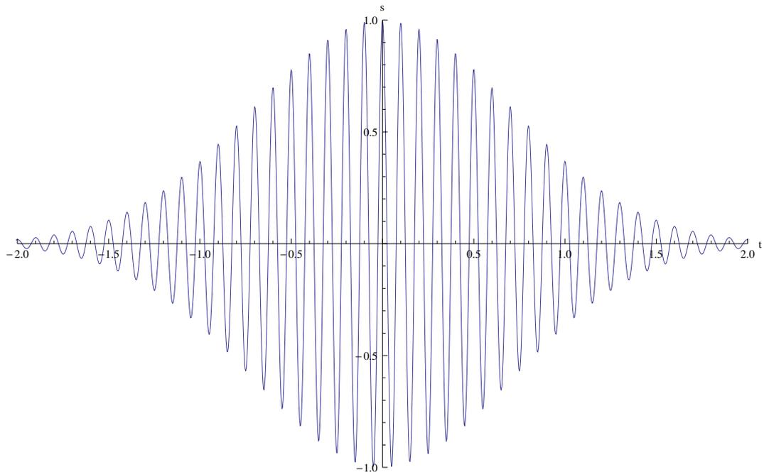
Dans ce cas, il faut choisir une fréquence d'échantillonnage supérieure à 2 fois la fréquence de la sinusoïde, c.a.d.  $N/T > 2/b$ .
