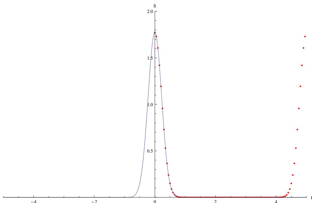
Le spectre obtenu doit être prolongé par périodicité de période  $N/T$  (5 sur l'exemple). Pour augmenter la résolution, il faut augmenter  $T$ . Il est intéressant de maintenir constante la fréquence d'échantillonnage  $N/T$  :
