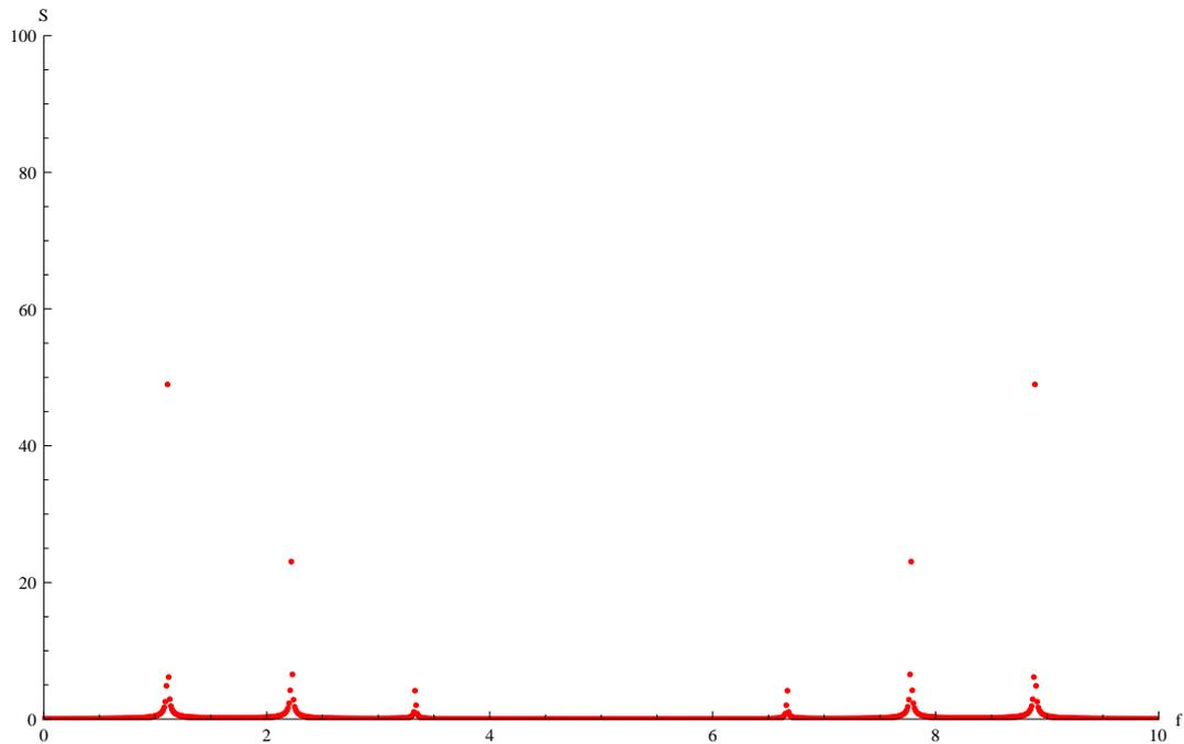
La base des raies est notablement plus large. Le signal échantillonné est en fait le produit du signal périodique défini ci-dessus par une fenêtre  $h(t)$  rectangulaire de largeur  $T$ . La TF est donc le produit de convolution de  $S$  avec la TF de  $h$  :
