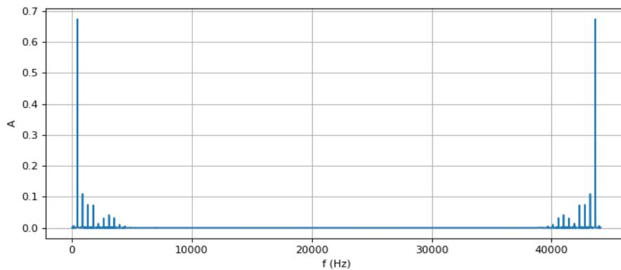
On s'intéresse au spectre du son en tant que signal continu, c'est-à-dire à la première moitié. Voyons le détail dans la bande  $[0, 5 \text{ kHz}]$  :
