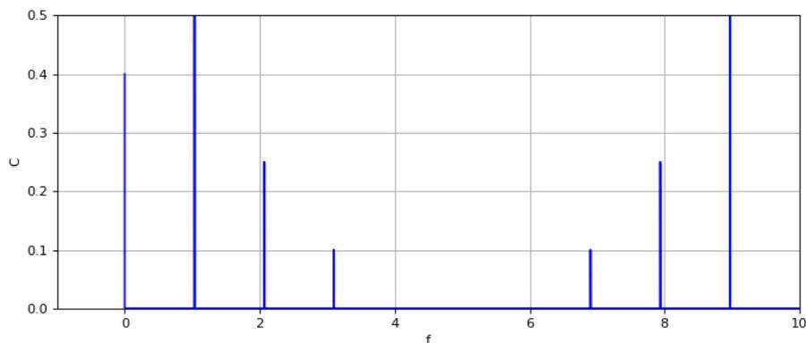
La résolution fréquentielle est bien meilleure. Les amplitudes des harmoniques attendues (d'après la définition du signal) sont correctes :  $c_0 = 0,4$ ,  $c_1 = 0,5$ ,  $c_2 = 0,25$ ,  $c_3 = 0,1$ . Remarque : on a ici utilisé la fonction `plot` et non `vlines` car cette dernière n'est pas optimisée pour le traitement d'un gros volume de données.
