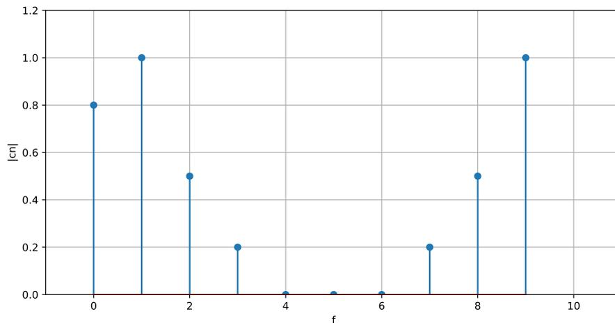
On remarque que la composante de fréquence nulle du spectre a une amplitude égale au double de la valeur moyenne. Dans le cas présent, on pourrait facilement diviser le terme d'indice 0 par deux pour obtenir directement la composante de fréquence nulle du signal, mais cette méthode n'est pas toujours applicable sur les spectres expérimentaux.
