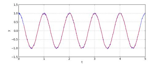
Le signal traité est bien synchrone avec le signal d'origine; les P premiers et les P derniers points sont perdus. Dans un filtre numérique temps-réel, la sortie serait retardée, c'està-dire décalée de  $\tau=PT_e$  vers la droite.
