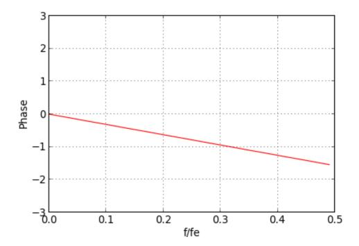
Le filtre moyenneur est un filtre passe-bas (assez peu sélectif). Le déphasage varie linéairement avec la fréquence. Cela se vérifie sur l'expression suivante de la réponse fréquentielle :
