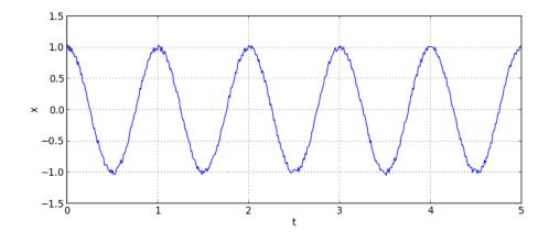
Pour obtenir le signal discret filtré, il faut effectuer la convolution avec la réponse impulsionnelle. La fonction scipy.signal.convolve permet de le faire. On utilise l'option mode='valid', qui restreint le calcul aux points valides. Ainsi le premier point calculé est la moyenne des deux premiers et le dernier point est la moyenne des deux dernier. Le premier point calculé correspond à l'instant  $T_e$ , c'est pourquoi l'échelle de temps doit être modifiée.
