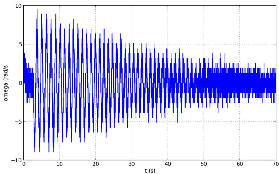
Le signal obtenu est très bruité. Cela est dû au fait que le filtre dérivateur amplifie le bruit du signal de départ. Ce bruit est visible lorsqu'on observe en détail le signal :
