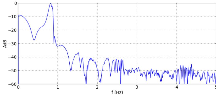
Ce spectre permet d'obtenir la fréquence des oscillations ( $0,8 \text{ Hz}$ ).
