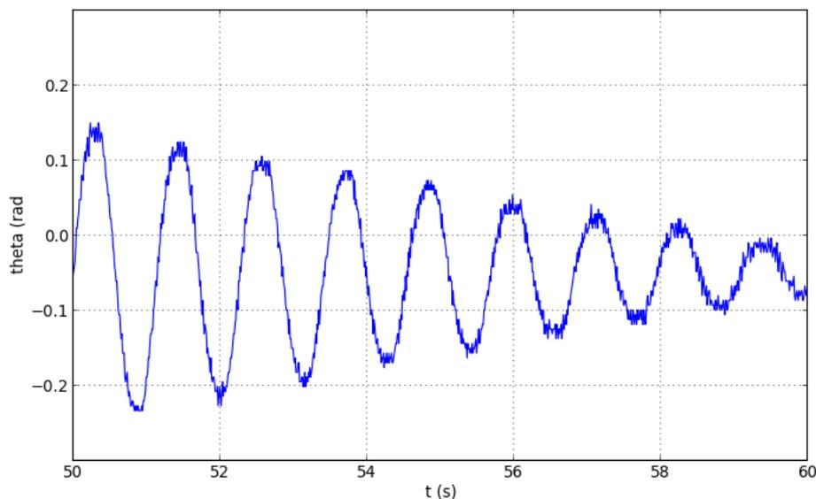
Il faut donc effectuer un filtrage passe-bas sur le signal de l'angle avant de calculer la dérivée. On choisit pour ce faire un [filtre à réponse impulsionnelle finie](#). Ce type de filtre
