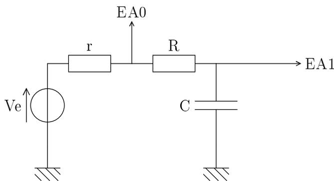
La source de tension représente la sortie audio de l'ordinateur, avec sa résistance de sortie  $r = 50 \Omega$ . On fait une acquisition à la fois sur le signal non filtré (EA0) et sur le signal filtré (EA1). Les valeurs pour le filtre sont  $R = 6.8 + 0.39 = 7.2 \text{ k}\Omega$  et  $C = 22 \text{ nF}$ , ce qui donne une fréquence de coupure de  $1.0 \text{ kHz}$ .
