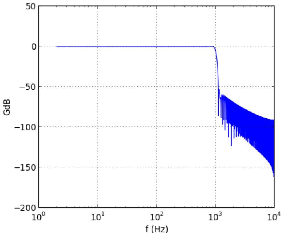
On constate que la chute du gain est très rapide, de  $-50$  décibels sur quelques Hertz. Cela est dû à la grande valeur choisie pour  $P$ . On obtient ainsi un filtre très sélectif, sans commune mesure avec ce qu'il est possible d'obtenir en filtrage analogique.
