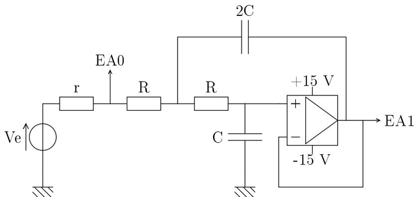
L'élément actif est un amplificateur suiveur. L'impédance de sortie du filtre est celle de l'amplificateur, ce qui lui donne une valeur assez faible, de l'ordre de quelques Ohms.
