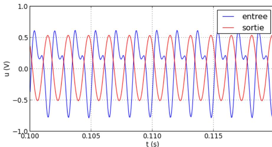
L'harmonique de rang 2 se trouve dans la bande atténuée, avec un gain pratiquement nul (de l'ordre de  $-50$  décibel). On obtient donc en sortie le fondamental. On voit ainsi la sélectivité très forte de ce filtre, capable d'isoler le fondamental de l'harmonique de rang 2, ce qu'un filtre analogique ne peut faire.
