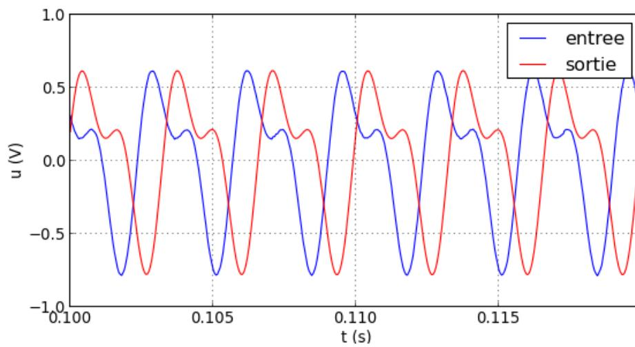
La sortie est identique à l'entrée, ce qui est logique car les deux harmoniques sont dans la bande passante, où le gain est égal à 1. Le décalage entre les deux est  $\tau = Pt_e = 5\text{ ms}$ . Le retard est plus grand que pour les filtres analogiques, mais celui-ci est proportionnel à  $P$ . Dans le cas présent, si  $P$  est supérieur à 100, le retard dépasse une période.
