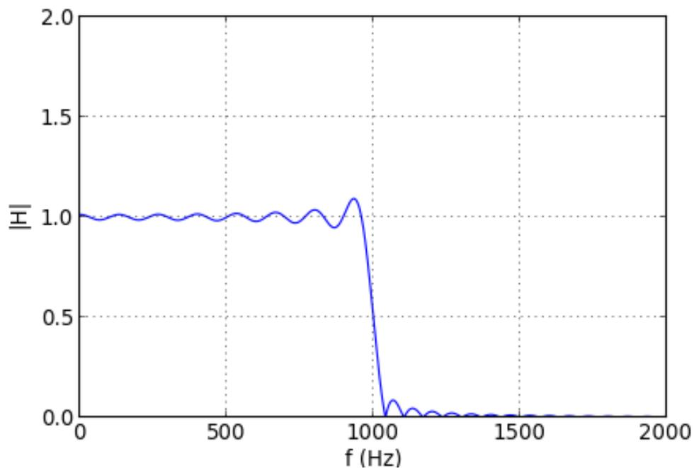
On est bien sûr assez loin du filtre idéal, parce-que la réponse impulsionnelle a été tronquée au rang  $P$ . Le plus gênant est la présence d'ondulations dans la bande passante. Pour les réduire, on utilise un fenêtrage progressif de la réponse impulsionnelle, par exemple un fenêtrage de Hamming :
