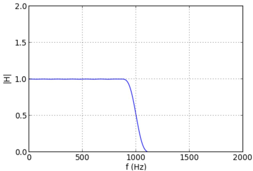
Il n'y a plus d'ondulations. On remarque que le gain à la coupure est  $1/2$ . Si l'on veut retrouver la définition de la coupure utilisée en filtrage analogique, il faut abaisser légèrement le paramètre  $a$ .
