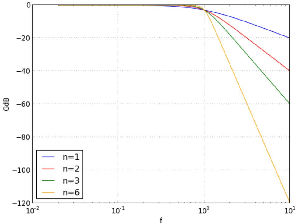
Dans la bande atténuée, le filtre d'ordre  $n$  présente une pente de  $-20n$  décibels par décade. Pour résumer, plus le filtre est d'ordre élevé plus le gain est constant dans la bande passante et plus le gain décroît rapidement dans la bande atténuée. On dit que la sélectivité du filtre augmente avec l'ordre.
