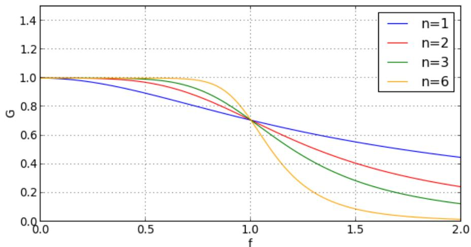
Le gain pour la fréquence de coupure est indépendant de l'ordre ( $G = 0.71$ ). On voit que le gain est loin d'être constant dans la bande passante. Pour obtenir un vraie bande passante, avec un gain constant sur une plage de fréquence assez large, il faut augmenter l'ordre du filtre. Si on s'intéresse à la variation du gain dans la bande atténuée, une courbe logarithmique est plus adaptée (diagramme de Bode) :
