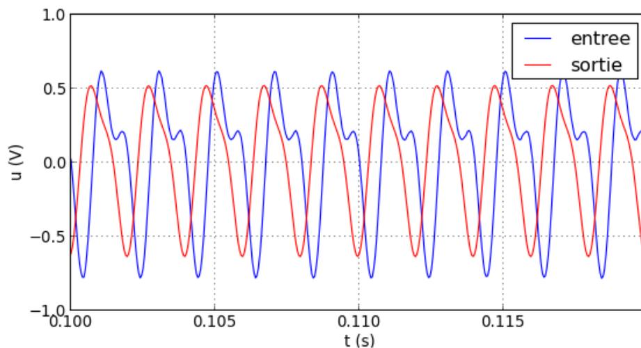
À cette fréquence, l'harmonique de rang 2 se trouve juste à la fréquence de coupure, avec un gain de 0.5, alors que le fondamental a toujours un gain de 1. Cela donne bien sûr une déformation importante en sortie. Voyons le résultat à 600  $Hz$  :
