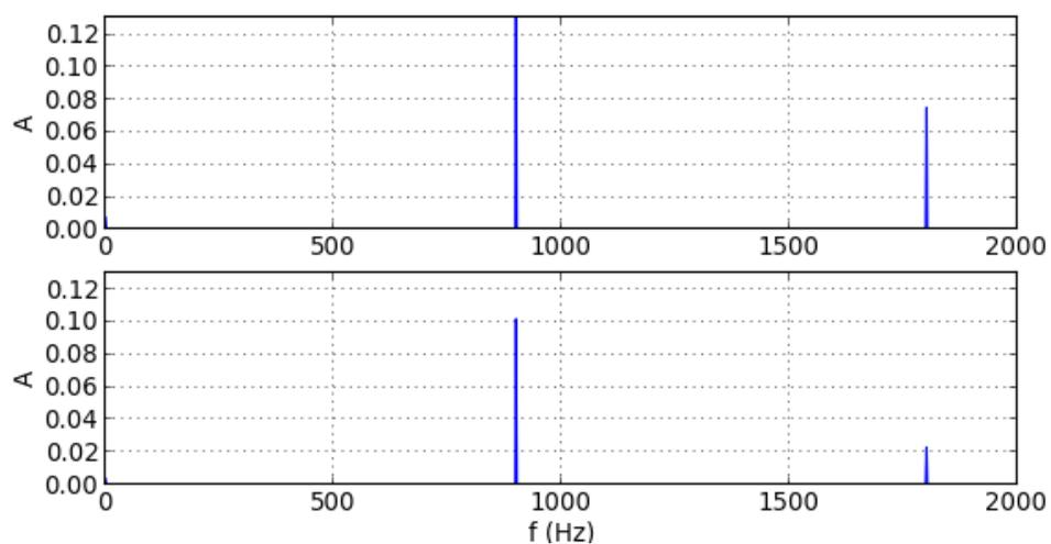
Comparé au filtre d'ordre 1, la déformation du signal dans la bande passante se produit à une fréquence un peu plus élevée, mais la différence est en pratique peu marquée. En revanche, l'effet de réduction de l'harmonique de rang 2 lorsqu'elle est dans la bande atténuée est nettement plus important.
