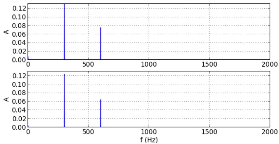
Bien que les deux harmoniques soient dans la bande passante, on commence à voir une légère déformation du signal, due au fait que l'harmonique de rang 2 est abaissée en sortie.
