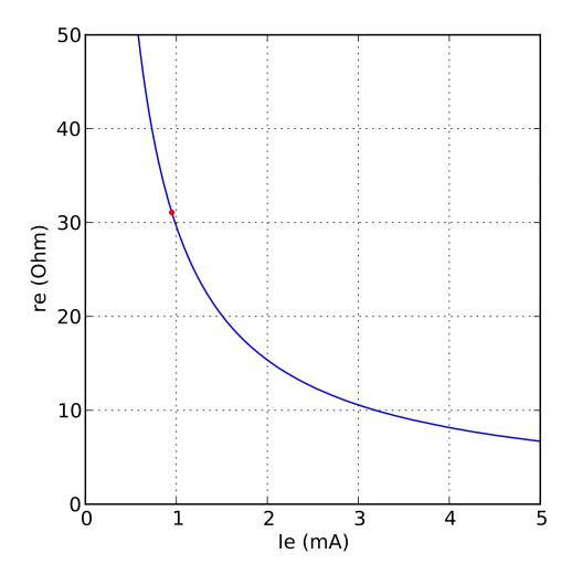
Pour le point de fonctionnement placé plus haut, cette résistance est d'environ  $r_e=30~\Omega$ . Elle augmente lorsque le courant d'émetteur décroît.
