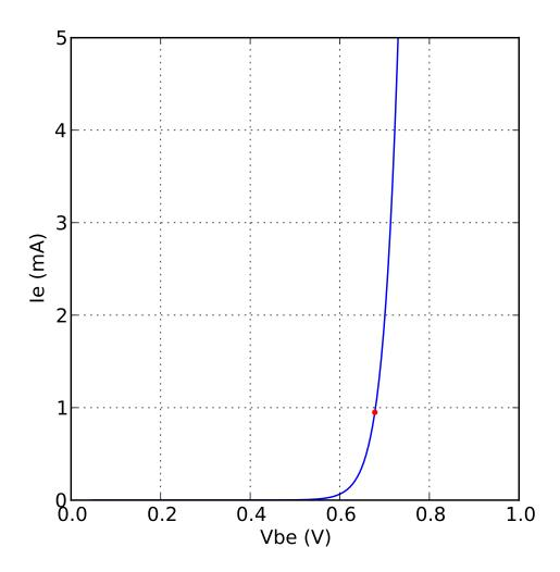
On a fixé  $V_{ce} = 5 \ V$  mais la courbe obtenue dépend très peu de cette tension, tant qu'on reste dans le domaine linéaire. Un point de fonctionnement a aussi été placé sur la courbe, à environ  $I_e = 1 \ mA$ . On s'intéresse à présent à une petite oscillation de la tension  $V_{ce}$  autour de ce point de fonctionnement, qui induit une oscillation du courant d'émetteur. Le rapport de la variation de tension sur la variation de courant est la résistance en alternatif d'émetteur :
