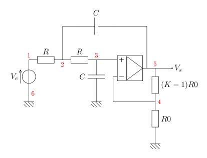
Il s'agit d'une structure de Sallen et Key avec un amplificateur de tension de gain K. En pratique, on utilisera un potentiomètre pour ajuster ce gain.
