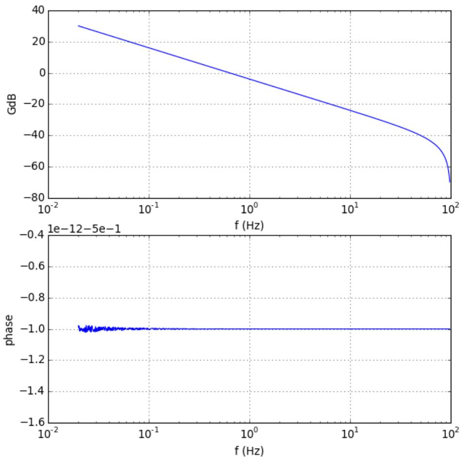
Il s'agit d'un intégrateur parfait, avec un déphasage égal à  $-\pi/2$  sur toute la gamme de fréquence. L'inconvénient d'un intégrateur parfait est son instabilité. En effet, un terme constant (de fréquence nulle) dans le signal conduit à une dérive de la tension en sortie, en raison du gain infini à fréquence nulle. On peut aussi calculer la réponse impulsionnelle de ce filtre :
