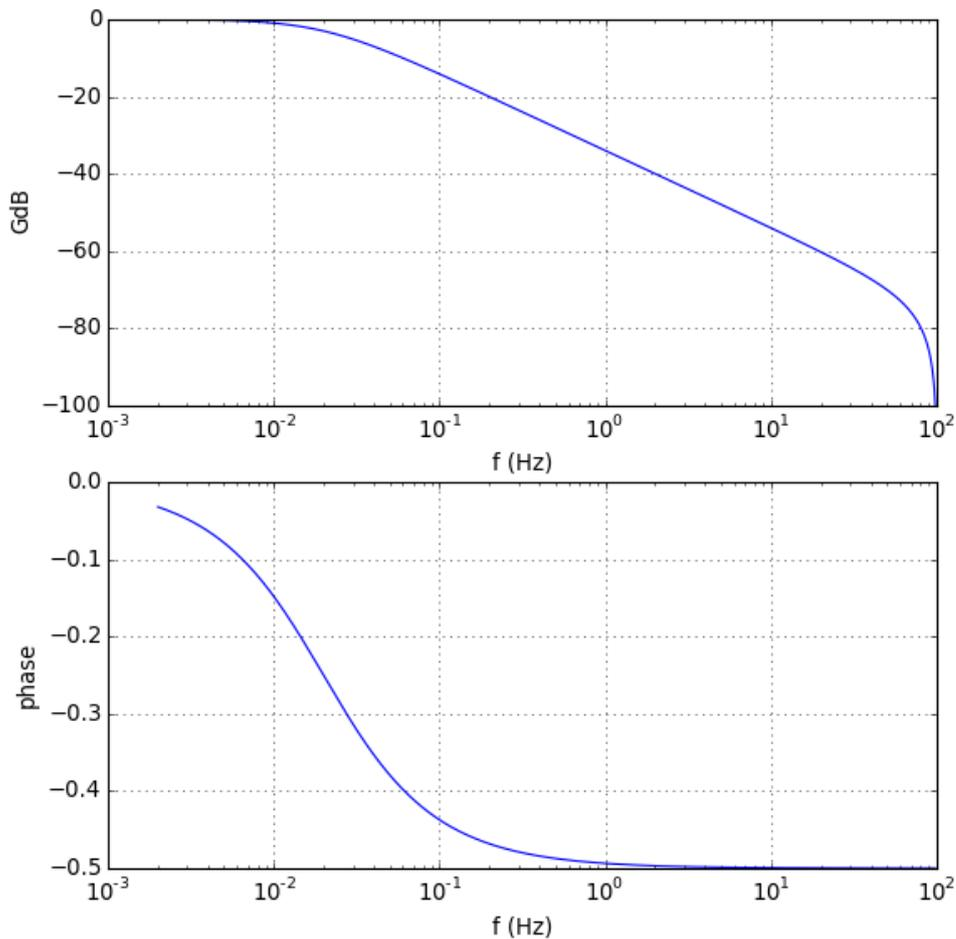
Le gain à fréquence nulle a une valeur finie, ce qui permet d'éviter la dérive à long terme. La fréquence de coupure est très basse, égale à  $0,02 \text{ Hz}$ , une valeur impossible à réaliser avec un filtre analogique RC.
