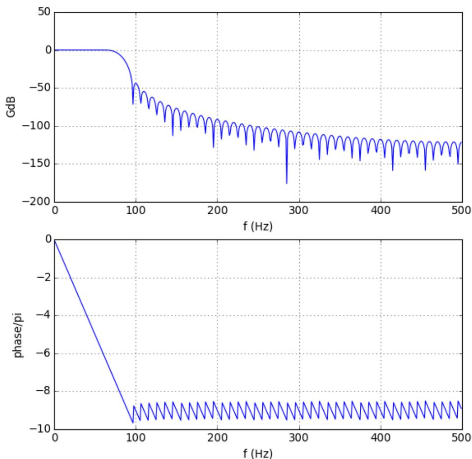
Les fréquences supérieures à la fréquence de Nyquist finale (100  $Hz$ ) sont atténuées à plus de 40 décibels.
