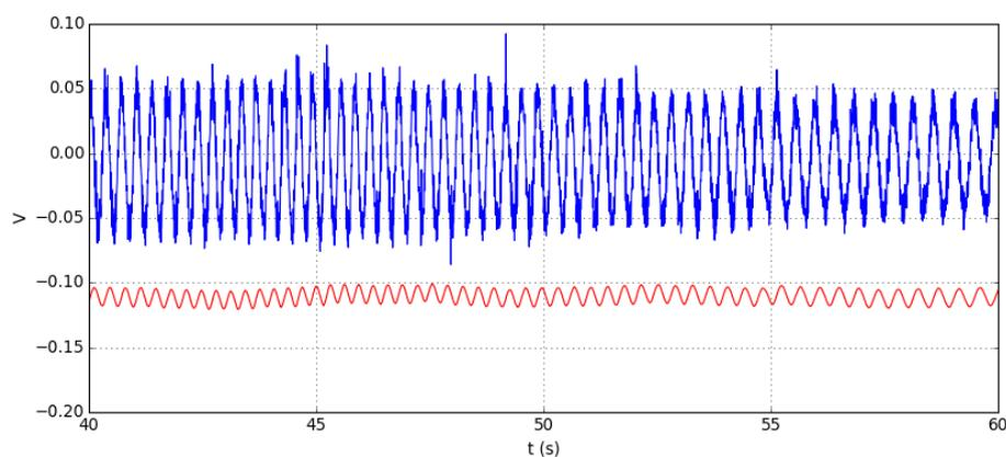
L'amplitude d'oscillation de la force électromotrice est plus grande (elle est proportionnelle à la fréquence), mais celle du flux est inchangée, conformément à la loi de Faraday.
