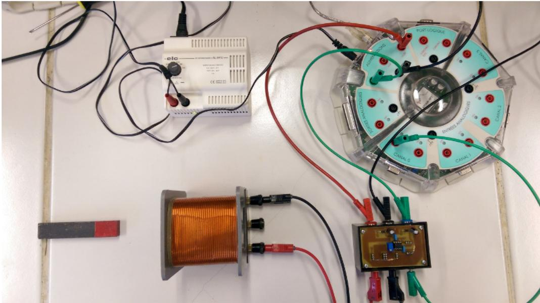
Pour la mesure du flux magnétique, l'aimant est déplacé à partir d'une position lointaine jusqu'à sa position finale. Le force électromotrice (le courant induit dans la résistance R1) est enregistrée au cours du temps.
