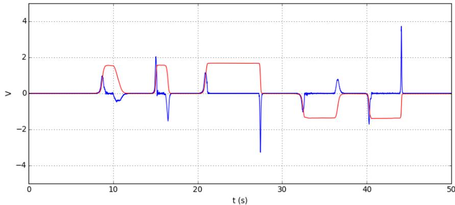
Le flux magnétique obtenu est celui de la position finale de l'aimant, qui est à peu près la même à chaque mouvement. La force électromotrice maximale est plus grande lorsque le déplacement est plus rapide. Cette expérience constitue une confirmation de la loi de Faraday, puisqu'elle montre que l'intégrale de la force électromotrice ne dépend que des positions initiale et finale de l'aimant.
