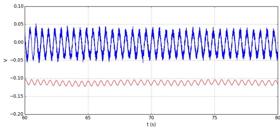
On voit bien l'effet passe-bas du filtre intégrateur : alors que la force électromotrice est très bruitée, le flux magnétique est bien lisse. La grandeur pertinente est l'amplitude d'oscillation du flux de crête à crête, qui est égale au double du flux magnétique lorsque l'aimant est aligné avec la bobine. Cette technique de rotation est donc un bon moyen de mesurer le flux créé par un petit aimant.
