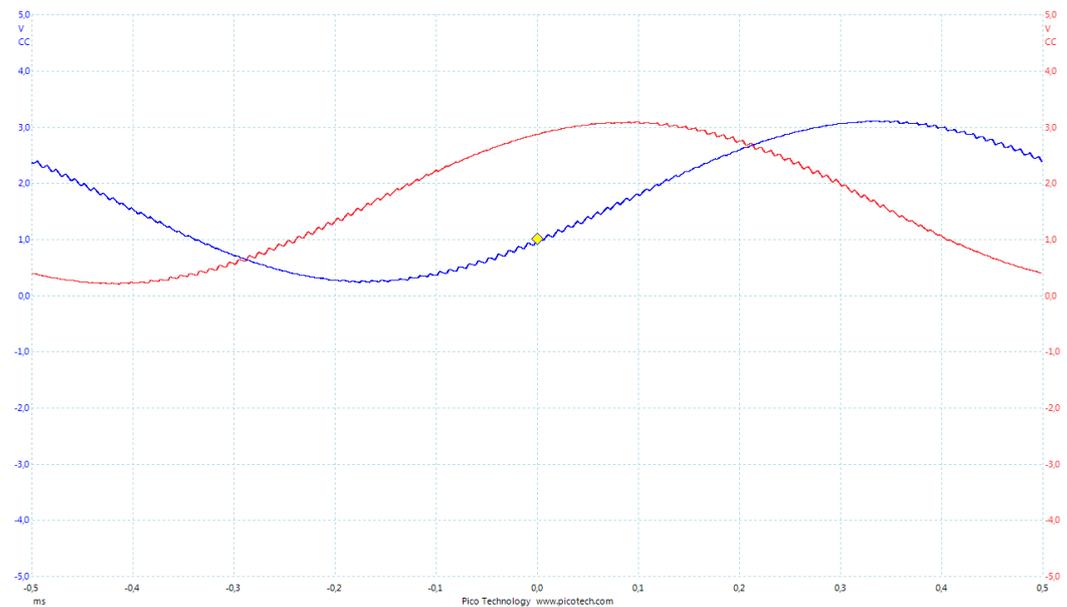
Voici un détail des deux signaux complémentaires (High et Low) PWM non filtrés, pour une des deux voies, sans temps mort :
