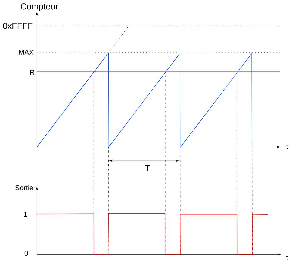
La fréquence d'horloge du compteur est la fréquence de base du microcontrôleur (84 MHz), ou bien un sous-multiple. Pour notre application, on souhaite générer un signal PWM dont la fréquence est de l'ordre de 100 kHz. La fréquence de base sera donc utilisée. Si  $f$  est la fréquence du signal, la fréquence de l'horloge doit être  $f * FMAX$ . Pour atteindre des fréquences de l'ordre de 100 kHz, il faut donc se limiter à une valeur de FMAX faible, par exemple :
