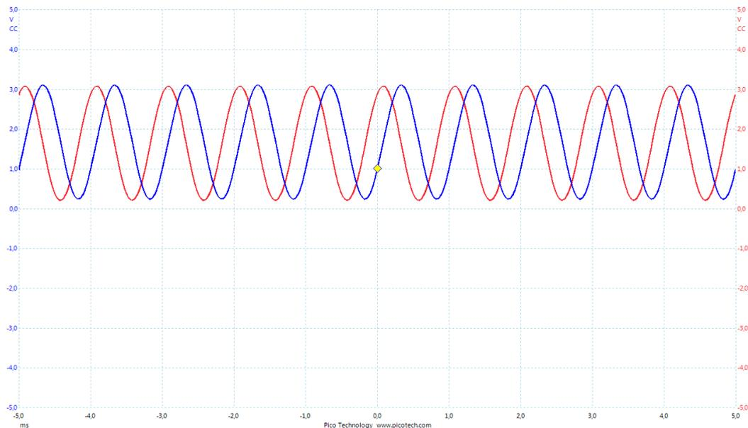
L'amplitude maximale des tensions de sortie s'étend de 0 à  $3,3 V$ . Sur cet exemple, la sinusoïde a l'amplitude maximale mais le gain du filtre RC est notablement inférieur à 1.
