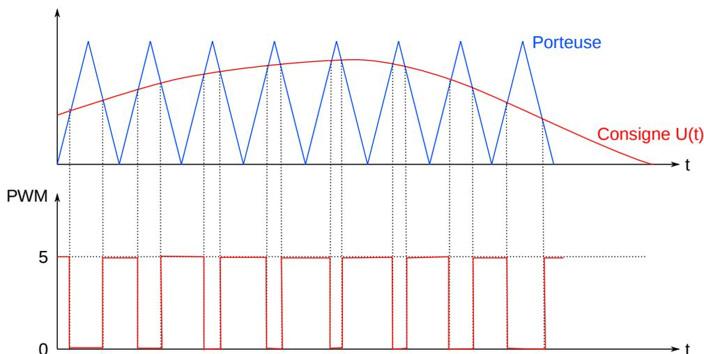
Le signal PWM obtenu doit subir un filtrage passe-bas pour en extraire le signal de consigne. Pour comprendre le principe de cette restitution, considérons le cas d'une consigne constante égale à  $U(t) = U_0$ . Le signal PWM est alors un signal carré dont le rapport cyclique est  $\alpha = U_0/m$ , où  $m$  est la valeur maximale de la porteuse. La moyenne de ce signal carré est précisément égale à  $U_0$ .
