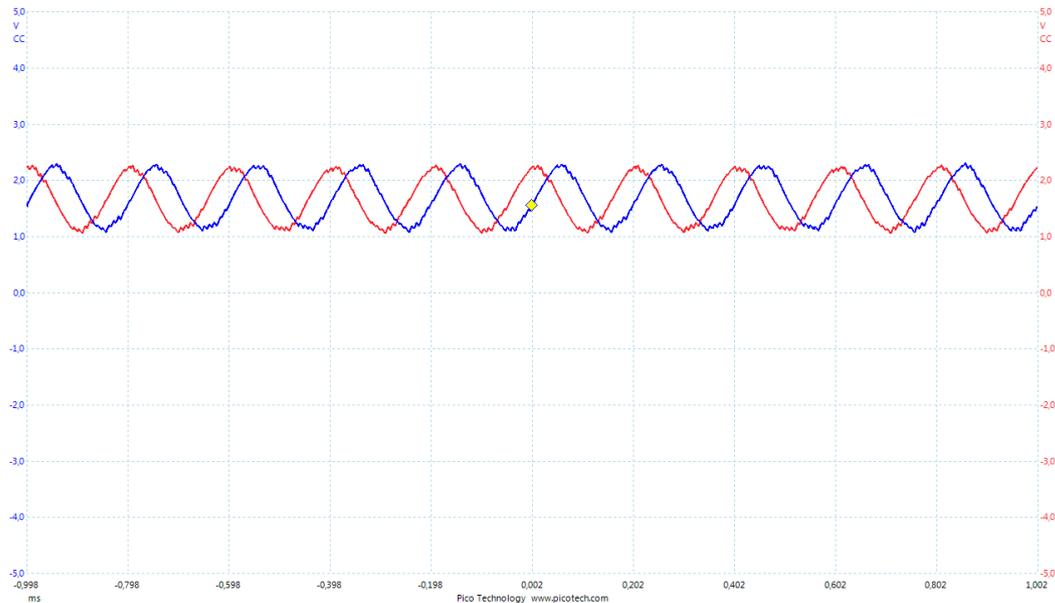
L'amplitude est plus petite à cause du filtre RC. La sinusoïde et le signal PWM sont dans la bande atténuante du filtre. Les ondulations sont bien visibles. Pour les réduire, il faudrait utiliser un filtre plus sélectif.
