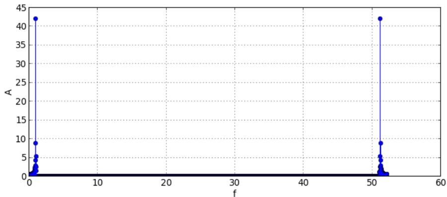
Cette opération effectuée dans le domaine fréquentiel revient à augmenter la fréquence d'échantillonnage sans perdre d'information. Il reste à effectuer la transformée de Fourier discrète inverse :
