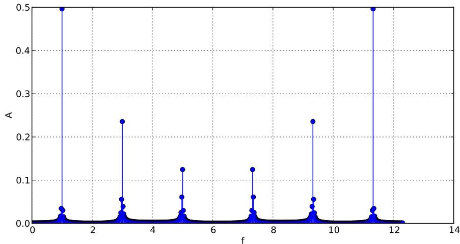
On voit sur ce spectre que la condition de Nyquist-Shannon est bien respectée : le spectre du signal continu, constitué des trois raies de fréquences 1,3 et 5, est bien obtenu sur la première moitié. Autrement dit, le spectre du signal et son image ne se chevauchent pas. Comme pour la sinusoïde, il est possible de reconstituer complètement le signal à partir des échantillons.
