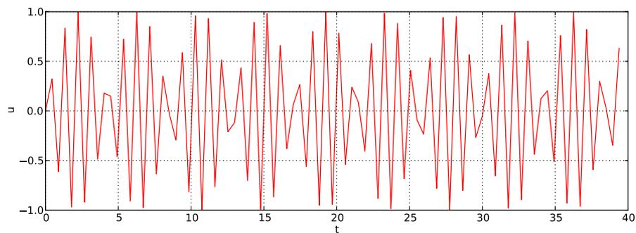
D'après le théorème de Shannon, il est pourtant possible de reconstruire complètement le signal. Pour le faire, nous allons plutôt nous placer dans l'espace des fréquences, en calculant la transformée de Fourier discrète des échantillons.
