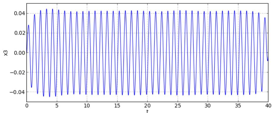
Bien que le résultat ne soit pas parfait, nous obtenons une reconstruction de la sinusoïde initiale. La formule de Shannon (4) s'applique à un signal non limité dans le temps. En pratique, il a une durée finie  $T$ , c'est pourquoi la reconstruction est imparfaite. Nous verrons plus loin que la reconstruction se fait en pratique dans le domaine temporel et non pas de cette manière.
