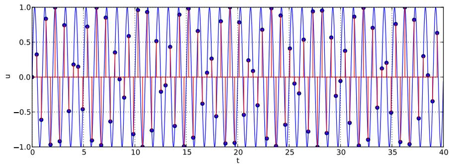
Si l'on relie les échantillons par des segments, on obtient bien sûr une très mauvaise représentation de la sinusoïde :
