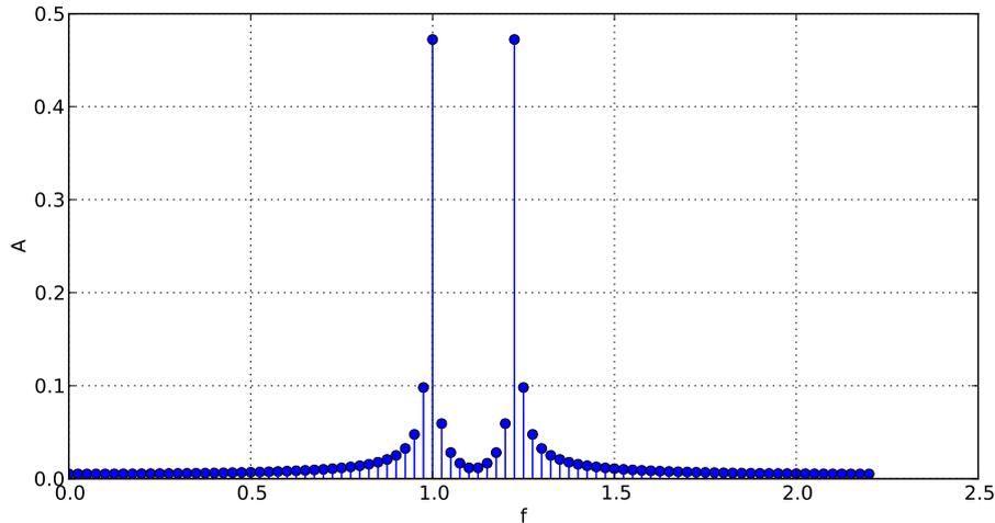
Le spectre du signal discret comporte deux maxima, le premier à la fréquence 1, et son image à la fréquence  $2.234 - 1$ . Nous allons couper la transformée de Fourier discrète en deux parties :
