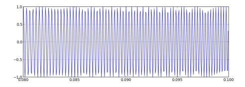
Cette fonction présente à la fois des variations lentes et des variations rapides. En modifiant le paramètre a, on peut augmenter ou réduire la présence des variations rapides. La transformée de Fourier discrète permet d'obtenir le spectre de ces échantillons. La résolution du spectre est l'inverse de la durée T.
