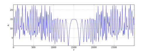
Les deux parties symétriques du spectre se sont mélangées. C'est évidemment une conséquence du non respect de la condition  $f_n > f_{max}$ . Le résultat est un spectre complètement modifié. Certaines parties du spectre image se sont repliées sur le spectre. Ce phénomène est appelé le repliement de bande. Il se produit en cas de sous-échantillonnage. Repliement de bande et aliasing sont deux manifestations (l'une fréquentielle et l'autre temporelle) du même phénomène.
