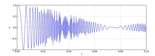
Le résultat est un signal dans lequel les hautes fréquences ont été atténuées (par le filtrage). L'aliasing est présent mais il est consérablement atténué. Le filtre moyenneur n'est pas le meilleur filtre passe-bas. Il est préférable d'utiliser un filtre passe-bas gaussien, comme expliqué dans Introduction aux filtres numériques..
