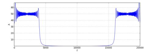
Le spectre s'étend de la fréquence nulle jusqu'à la fréquence d'échantillonnage  $f_e$ . La moitié de la fréquence d'échantillonnage est appelée la fréquence de Nyquist,  $f_n = f_e/2$ . On remarque que le spectre est symétrique par rapport à cette fréquence. La partie de droite est l'image du spectre de la fonction continue.
