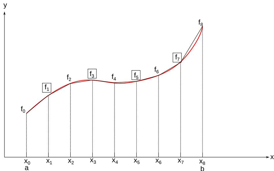
On remarque que la somme  $S_p$  peut être réutilisée pour calculer  $S_{p+1}$ . Il suffit d'ajouter les points milieux, encadrés sur la figure.
